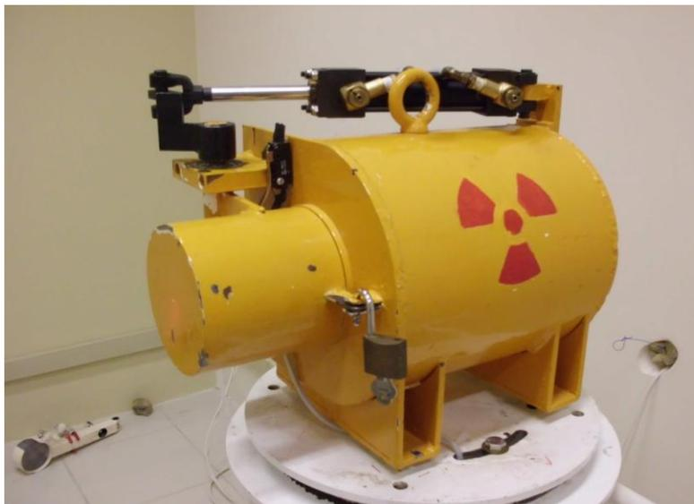
**Figura 12 – Sistema de fonte de radiação de  $^{137}\text{Cs}$  do laboratório de fonte de radiação de  $^{137}\text{Cs}$  do SECCAL/CRCN-NE.**
