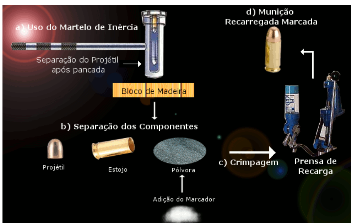
Figura 12 – Esquema mostrando a sequência para obtenção de munições marcadas. Com o uso do martelo de inércia (a) separou-se os componentes da munição (b). Em
