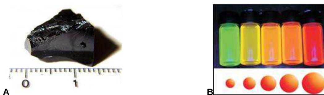
Fig. 1.12 (A) Aspecto do cristal macroscópico de CdTe. (B) Demonstração da relação entre o comprimento de onda de fluorescência e a variação no tamanho dos pontos quânticos, de 2-4 nm (CHEMISTRY RESOURCE, 2011; SILVA et al. , 2010).
