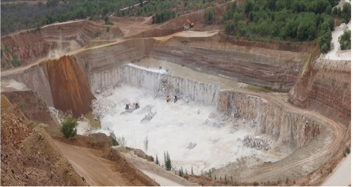
**Figura 3.2** – Reposição do material estéril na cava – *Terrace Mining*.
