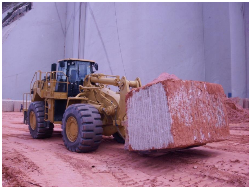
Figura 3.11: Empilhadeira realizando o transporte de um bloco para o pátio de estocagem.
