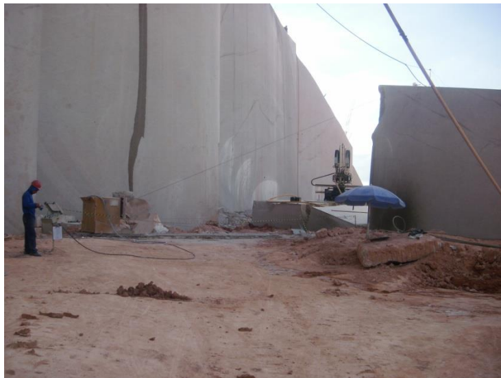
Figura 3.5: Execução de corte com máquina de diamantado.
