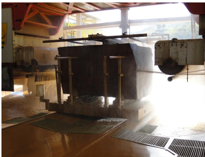
Figura 7.17: Tear multifio realizando desdobramento do bloco.
