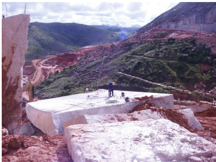
Figura 3.10: Funcionário realizando a colocação de cunhas com martetele pneumático.
