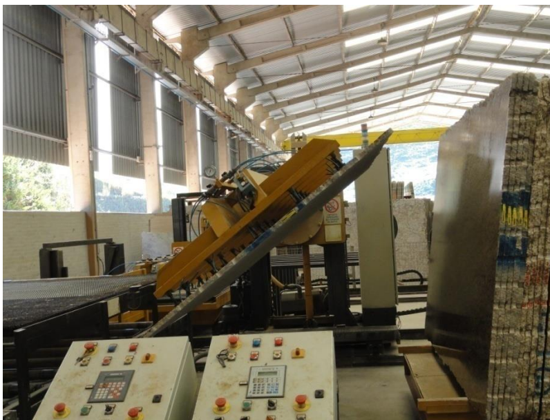
Figura 7.23: Chapa sendo retirada da linha de resinação por sistema automatizado.
