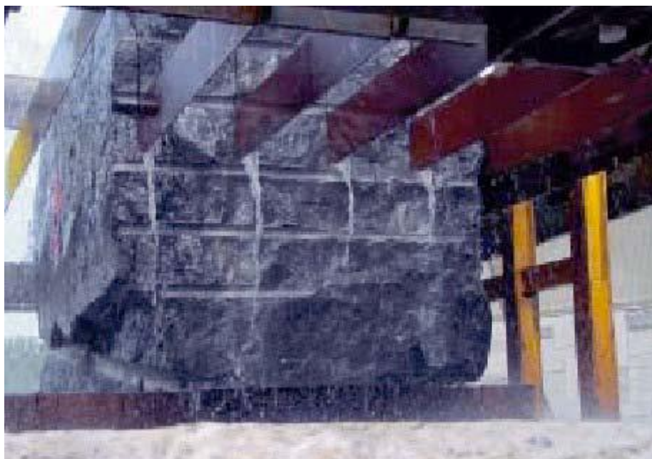
Figura 5.1: Tear multilâminas realizando o desdobramento de um bloco de granito (Fonte: CAVAZZANA, 2005)
