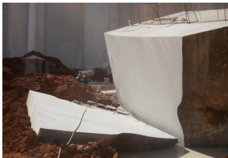
Figura 7.7: Prancha individualizada por fio diamantado pronta para a obtenção de blocos.
