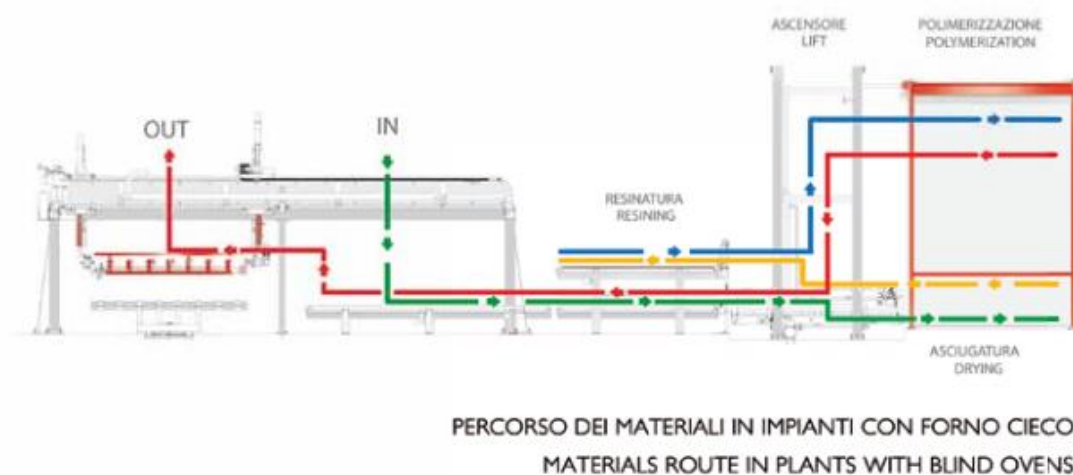
Figura 7.21: Fluxograma do processo de resinação das chapas de mármore e granitos.
