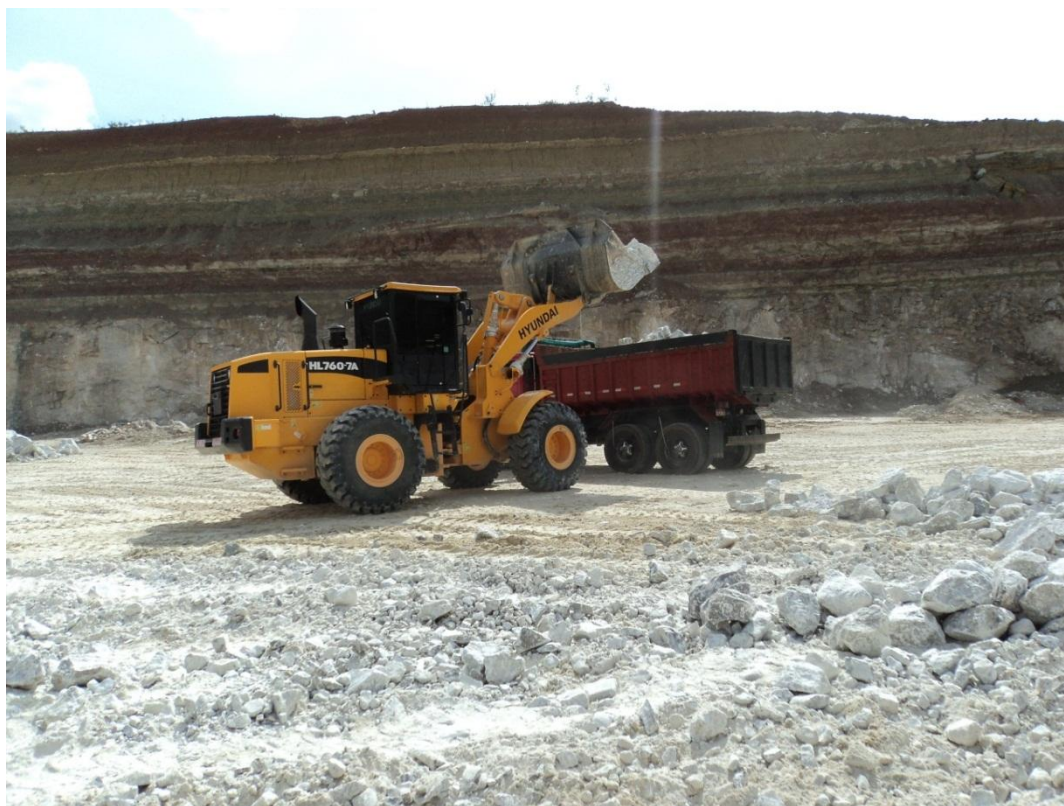
Figura 3.4 - Carregamento de gipsita com uso de pá-carregadeira sobre pneus
