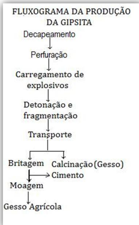
Figura 2.1 - Fluxograma de produção de gipsita
