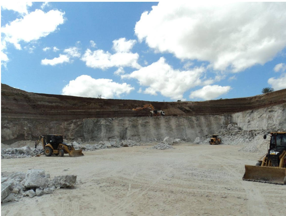
Figura 3.1 - Método de lavra em cratera da Mina Ponta da Serra
