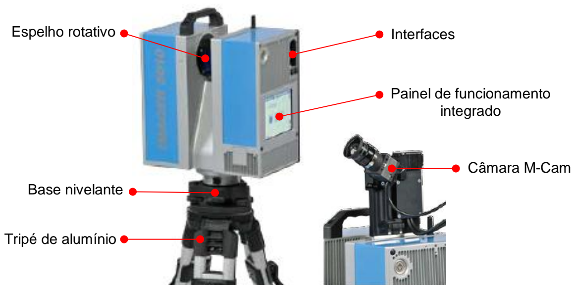
Figura 25 - Visão geral do laser scanner Z+F IMAGER 5010 e da câmara M-Cam.
