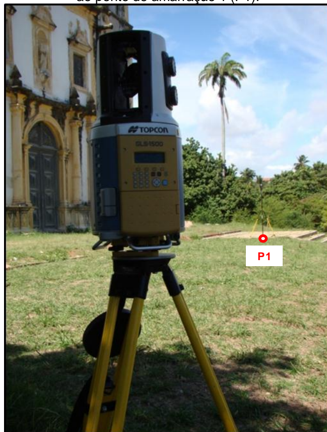
Figura 44 - Laser scanner Topcon GLS-1500 posicionado na estação 1 e orientando-se em relação ao ponto de amarração 1 (P1).
