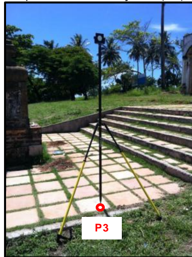
Figura 45 - Detalhe do ponto de amarração 3 (P3) da varredura a laser .
