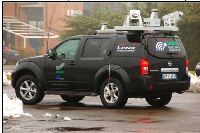
Figura 22 - Utilitário com os componentes do sistema cinemático Lynx Mobile Mapper.
