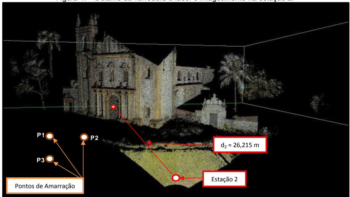
Figura 47 - Detalhe da varredura a laser e imageamento na estação 2.
