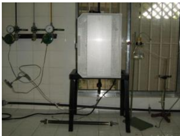
Figura 8. Forno Lindeberg/Blue usado para a calcinação e redução dos catalisadores.
