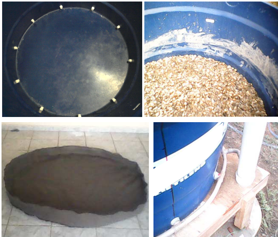
Figura 23: Detalhes da construção do lisímetro com lençol freático controlável. Na última foto observa-se a marcação para a colocação do sensor de umidade do solo no perfil.
