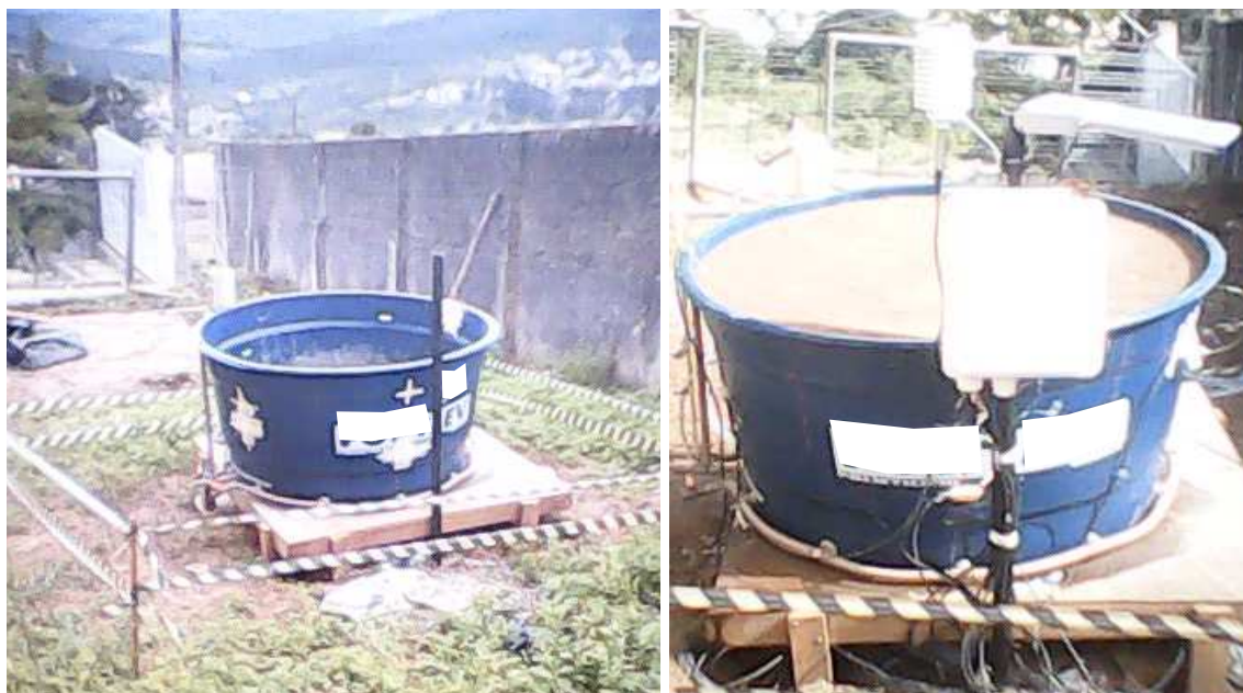
Figura 24: Sítio experimental em Garanhuns. Caixa instalada e instrumentada com sensores, central de aquisição de dados e painel solar.
