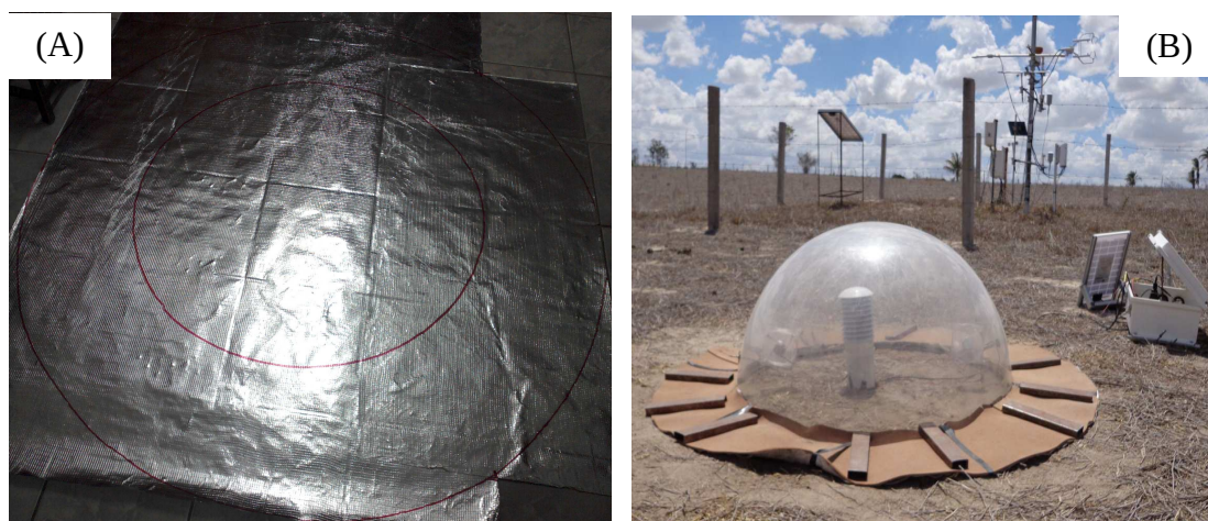
Figura 14: Bordadura isolante: composta de duas camadas de emborrachado EVA, entre os quais é instalada a manta térmica Durafoil . Observam-se, também, os pesos de aço sobre a bordadura. Domo instalado ao lado da estação meteorológica em São João.
