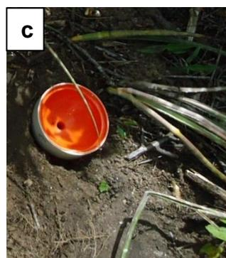
Figura 4. Interceptômetros na área de caatinga, tipo funil a 1m acima da superfície do solo (a), tipo calha rente a superfície do solo (b) e tipo funil a 10-15 cm acima da superfície do solo (c), Fazenda Pendência, Soledade, PB, Brasil.
