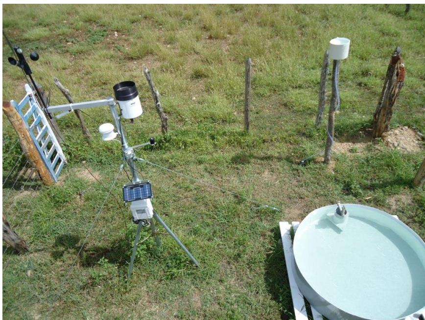
Figura 1. Estação meteorológica, tanque classe A e pluviômetro artesanal na área experimental entre o pasto e a caatinga, Fazenda Pendência, Soledade, PB, Brasil.
