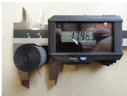
Figura 2.32 – Monólito de Fecralloy® de 18 mm de diâmetro e 3 cm de altura calcinado a 900°C durante 22 h.
