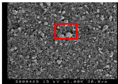
Figura 2.52 – Micrografia eletrônica a 1000 vezes (pré-catalisador de NiO/CeO 2 -γ-Al 2 O 3 sobre Fecralloy®). Região destacada apresentada na Figura 2.53.
