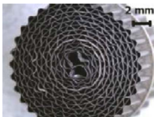
Figura 2.17 – Micromonólito com 510 \text{cm}^2 de superfície disponível, de 16 mm de diâmetro e 3 cm de comprimento. Fonte: Almeida et al. (2011).
