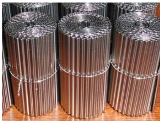
Figura 2.31 – Monólitos de Fecralloy® de 18 mm de diâmetro e 3 cm de altura após sua montagem.
