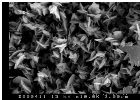
Figura 2.51 – Liga de Fecralloy® calcinada a 900°C por 22 h.
