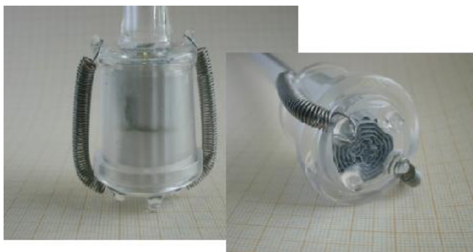
Figura 2.44 – Bulbo de vidro contendo um monólito de 16 mm de diâmetro e 3 cm de altura.
