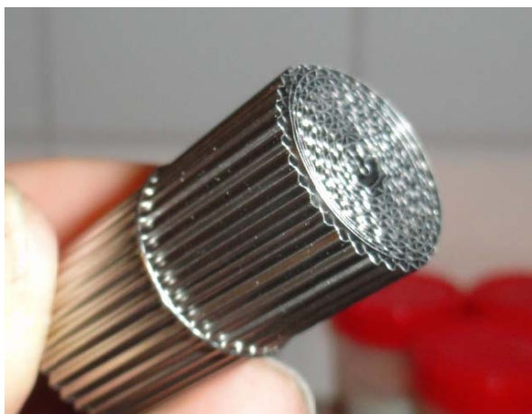
Figura 5.1 – Vista lateral inclinada de um monólito de \varnothing = 18 mm e h = 3 cm de altura (ou z = 3 cm de comprimento).
