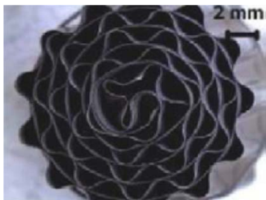
Figura 2.16 – Monólito com 258 \text{cm}^2 de superfície disponível, de 16 mm de diâmetro e 3 cm de comprimento. Fonte: Almeida et al. (2011).
