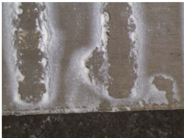
Figura 2.48 – Catalisador recobrindo a região da borda da lâmina lisa de um monólito. Ampliação de 4 vezes.
