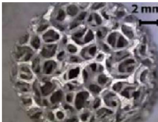
Figura 2.18 – Espuma metálica 140 cm 2 de superfície disponível, de 16 mm de diâmetro e 2,5 cm de comprimento. Fonte: Almeida et al. (2011).
