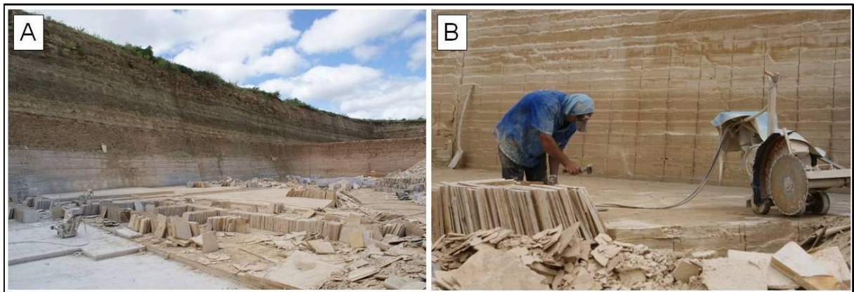
Figura 9: A) Vista geral do afloramento; B) Extração de calcário laminado para a construção civil.
