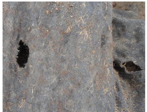
Figura 16- Situação da manta filtrante retirada dos telhados verdes.
