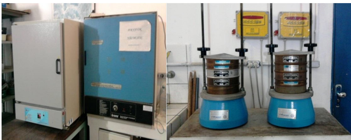
Figura 39(5)- A. Estufa para secagem; B. Peneiramento seco. Laboratório LGGM-CTG-UFPE.
