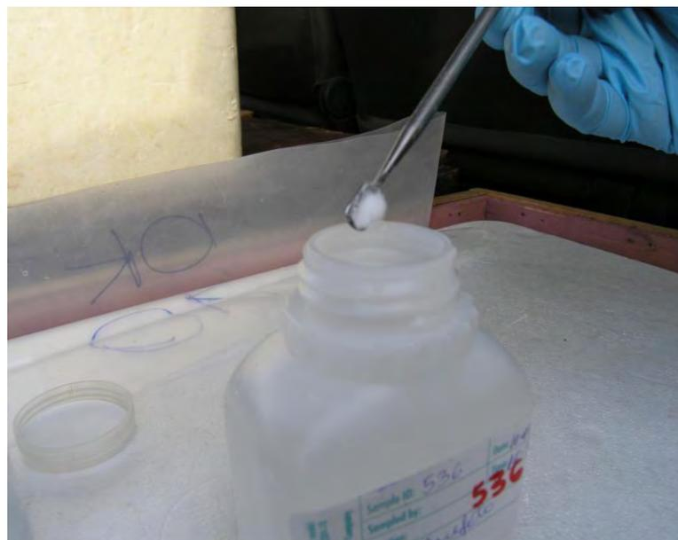
**Figura 5.8** - Preservação das amostras na determinação analítica dos metais dissolvidos.
