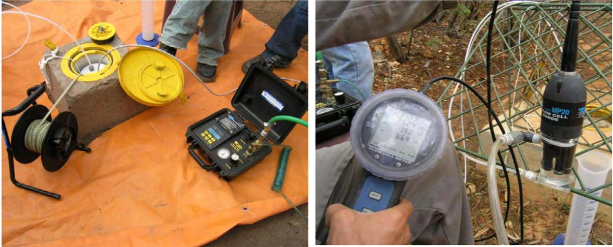
**Figura 5.2** - Funcionamento do sistema de bombeamento e detalhe da célula de fluxo para leitura e estabilização dos parâmetros.
