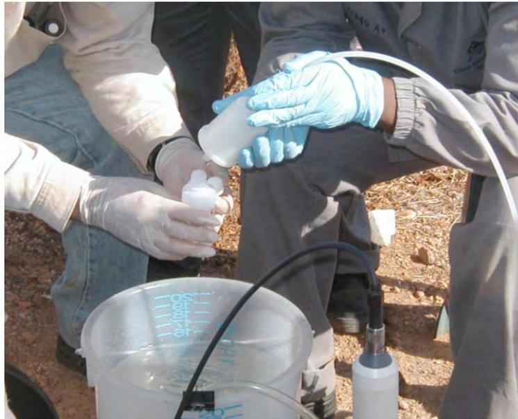
**Figura 5.7** - Coleta da alíquota filtrada com o uso de um filtro descartável de porosidade 0,45  $\mu\text{m}$ .
