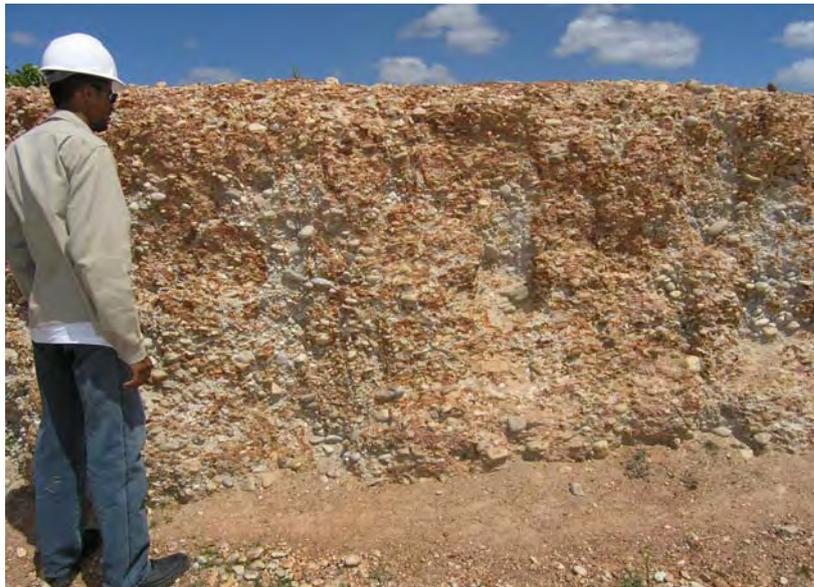
**Figura 3.16** - Cascalheira de coloração variável, com seixos de tamanho igualmente variável, na área de Estreito.
