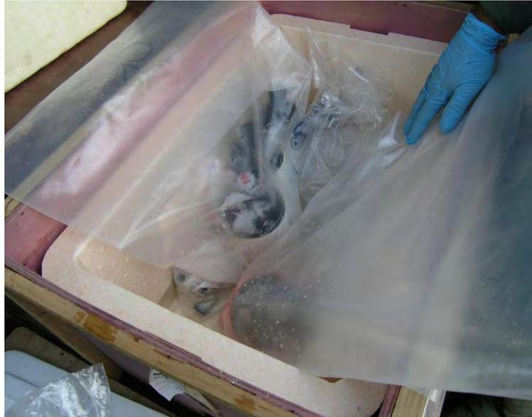
**Figura 5.9** - Acondicionamento das amostras em caixa de isopor refrigeradas com gelo e inseridas em caixa de madeira para conservar a temperatura necessária.
