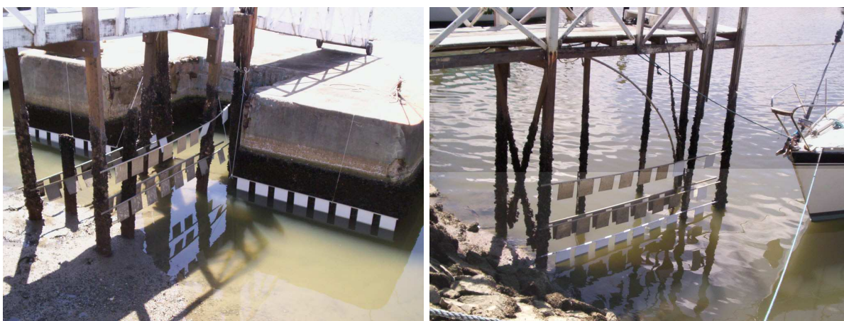
Figura 016. Pier 1 e Pier 2 (respectivamente) no Cabanga Iate Clube de Pernambuco onde foram colocadas as placas de PVC, para observar o recrutamento da fauna incrustante.
