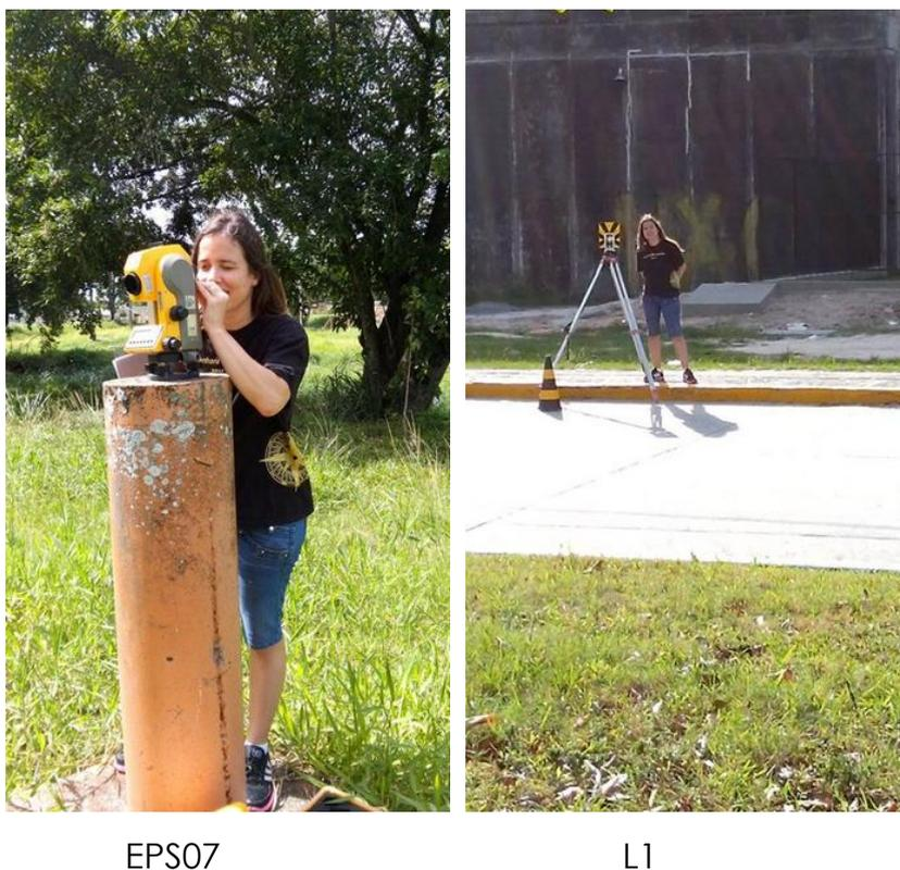
Figura 41– Vértice EPS07 e instalação do prisma no vértice L1. Foto: Dezembro de 2013.
