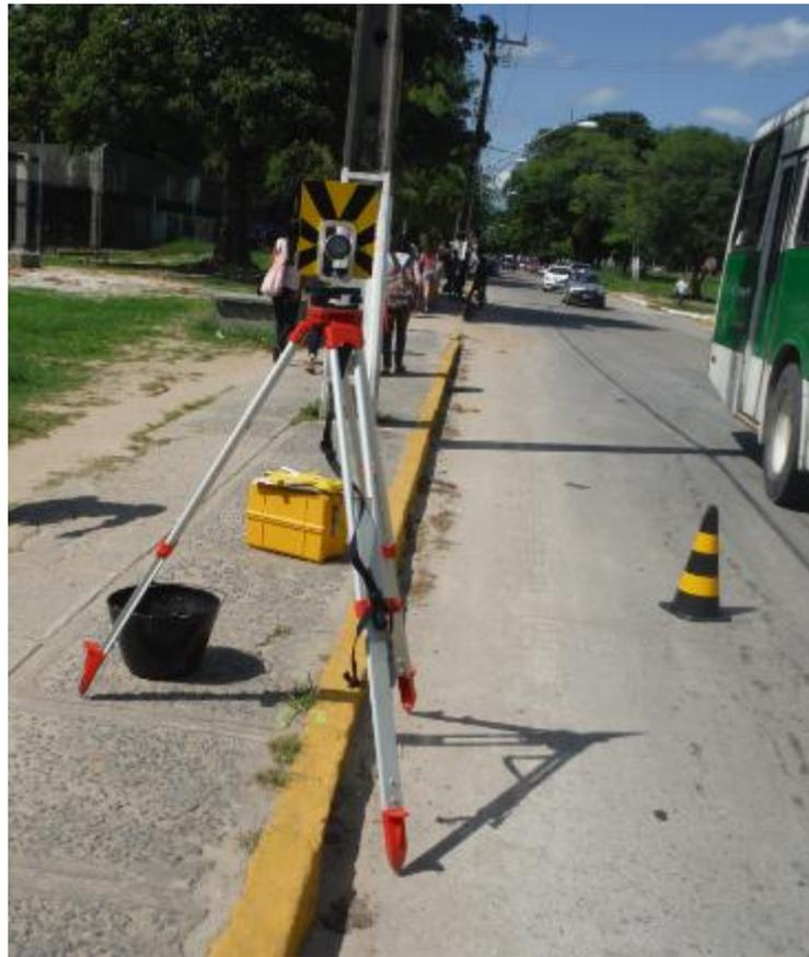
Figura 63 – Verificação dos pontos locados pelo método de irradiação e emprego de bastão e prisma. Fotos: Janeiro 2014.
