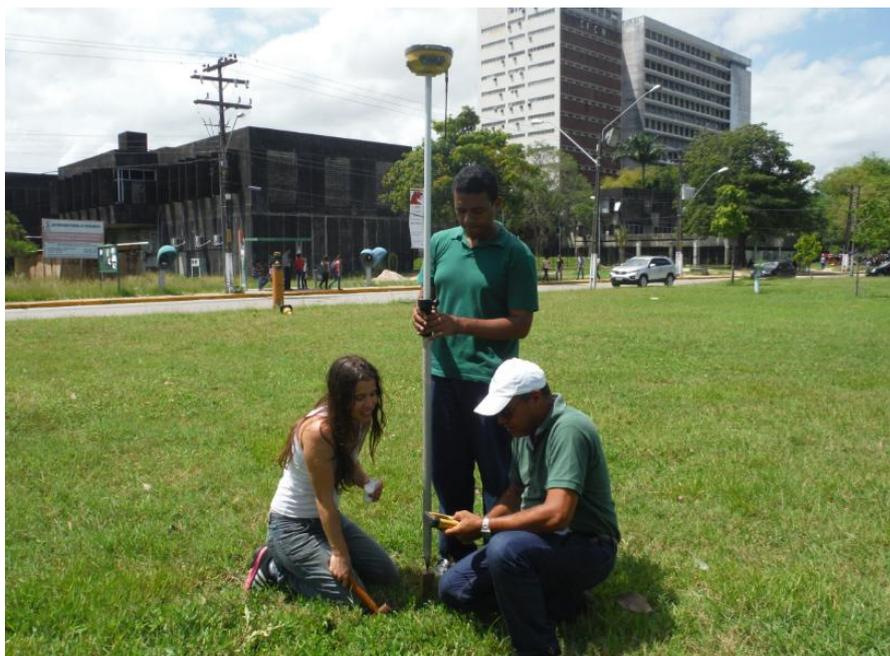
Figura 60 – Locação do ponto A pelo método de posicionamento RTK. Fotos: Janeiro 2014.
