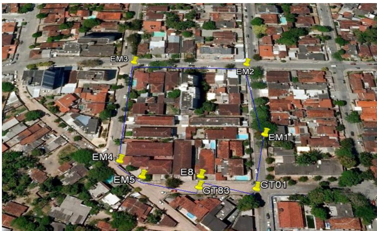
Figura 39 – Vértices da Poligonal implantada externa à obra no Bairro da Madalena. Fonte: Google Earth2013.
