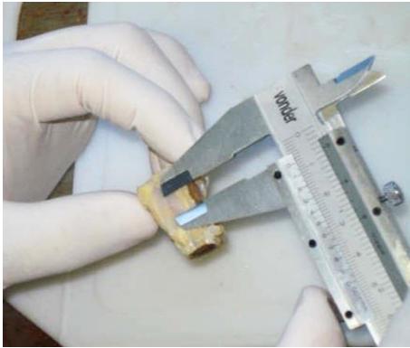
Fig. 28. Medição dos defeitos críticos
