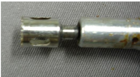
Fig. 3. Broca trefina de 11 mm para demarcação do defeito
