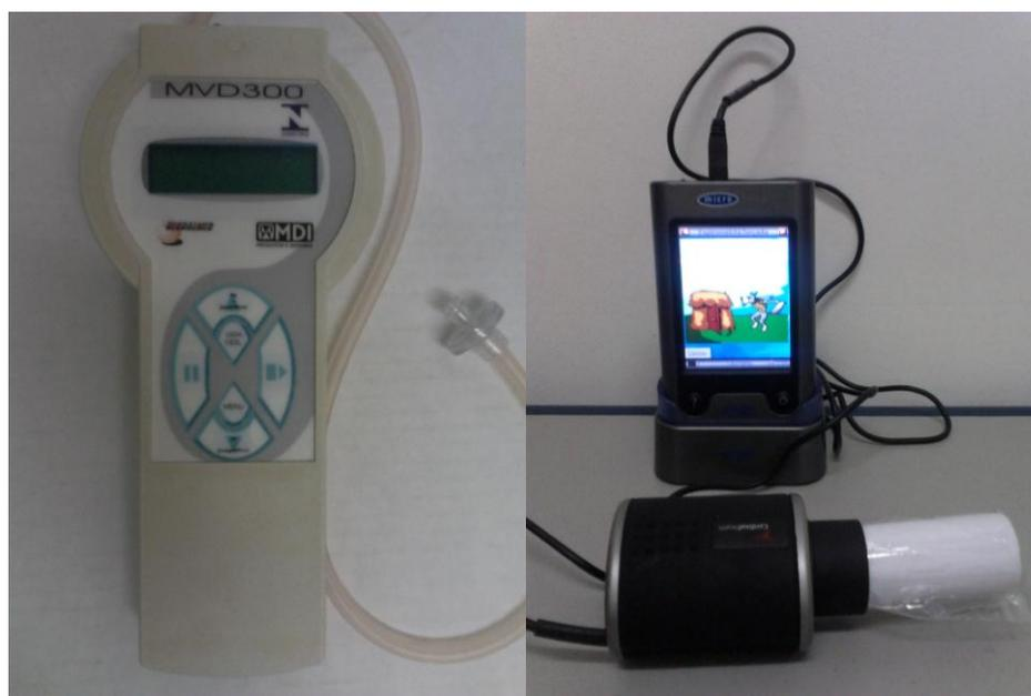
**Figura 03:** manovacuômetro e espirometro digitais com suas respectivas boquilhas
