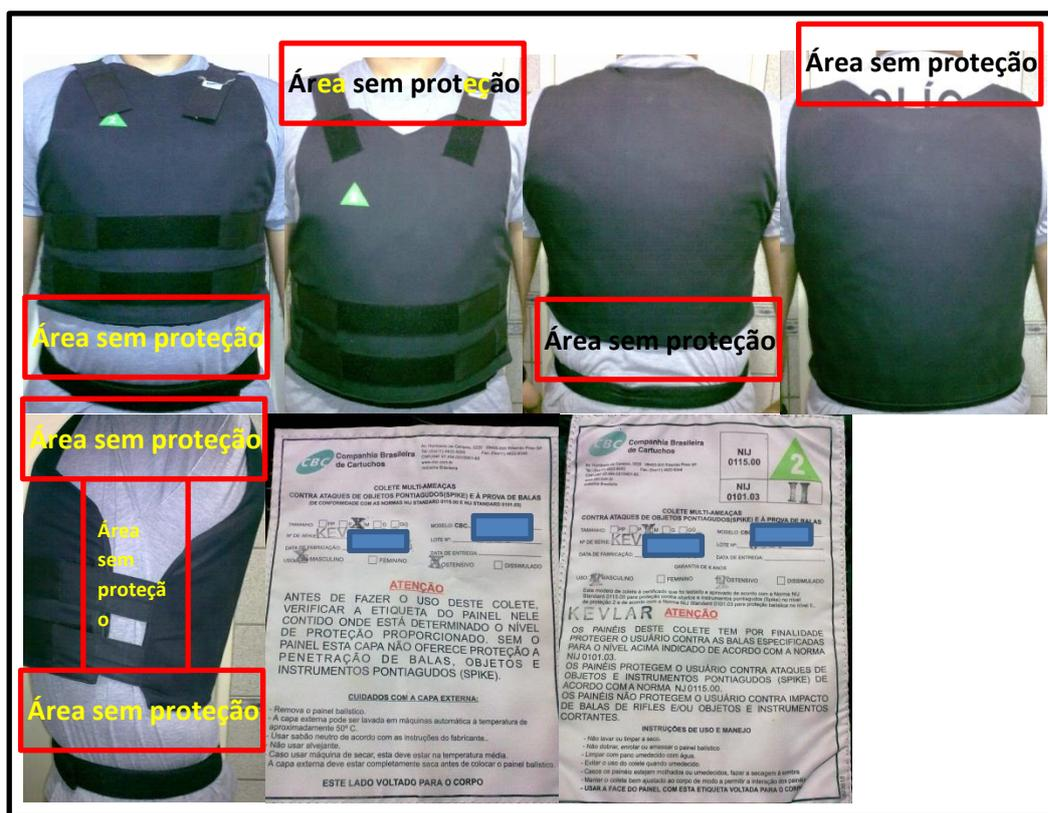
Figura 6 – Colete APB inadequado quanto à área de proteção. Fonte: O Autor (2012).
