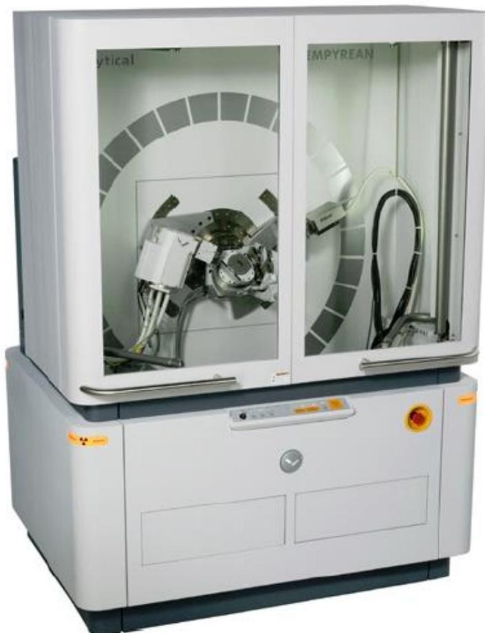
Figura 9 – Difratorômetro de raio-x *Empyrean, Panalytical* utilizado para caracterização mineralógica da cinza de Algaroba. Fonte: Romano, (2013).
