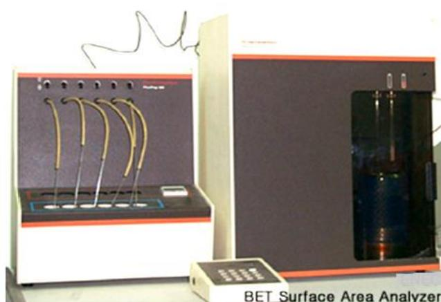
Figura 6 – Equipamento para medida da área de superfície específica, Gemini 2375, Micromeritics.
