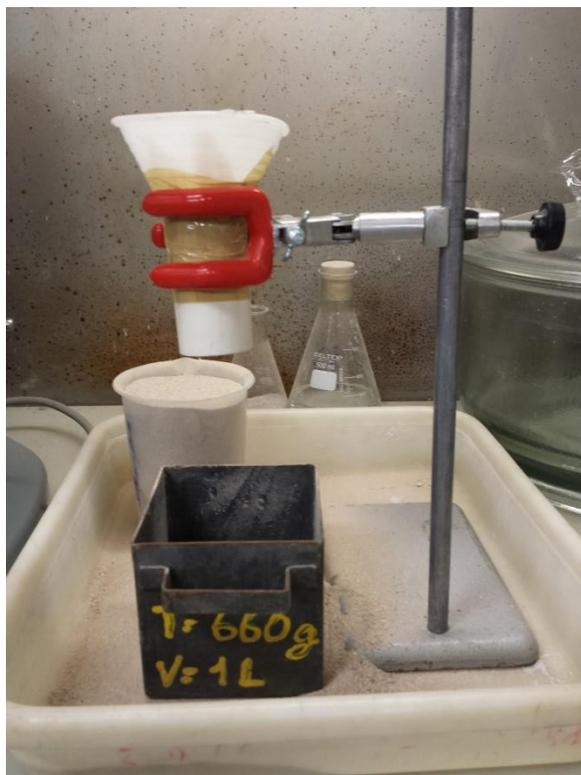
Figura 4 – Aparatos usados para determinação da massa unitária das matérias primas. Fonte: Figura do autor, 2014.
