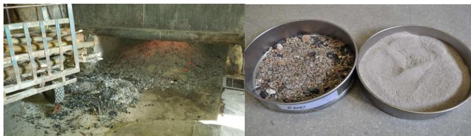
Figura 3 – Tratamento do cinza de Algaroba, através de peneiramento. Fonte: (LELOUP, 2013) figura adaptado pelo autor, 2014.
