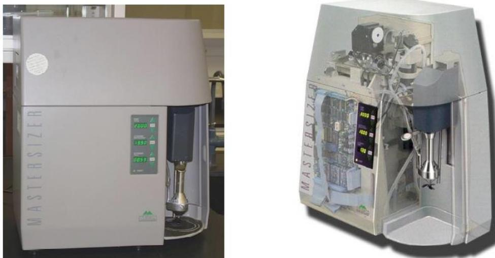
Figura 5 – Granulômetro a laser, Malvern – Mastersizer S long bed Ver 2.19, utilizado para caracterização da distribuição dos diâmetros de partículas. Fonte: (ROMANO, 2013).
