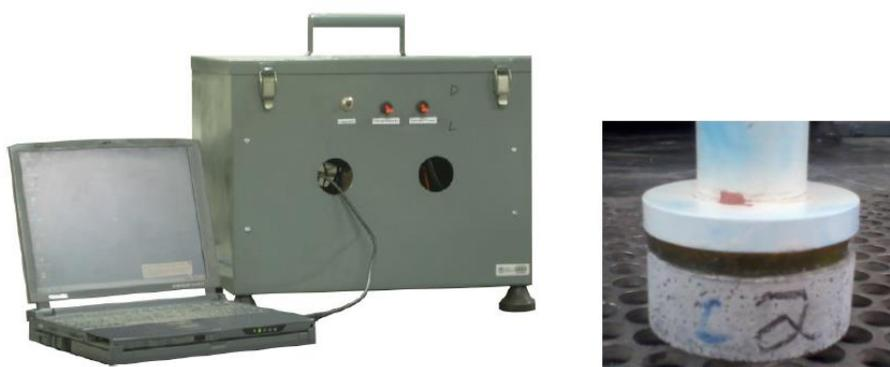
Figura 18 – Equipamento para avaliação da permeabilidade de superfície, *vacum-decay*. Fonte: Mario S. Takeashi.
