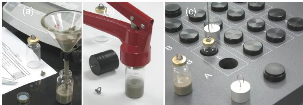
Figura 16 – Preparação das amostras para realização dos ensaios de calorimetria de condução isotérmica. (a) Adição da mistura de finos e água nos recipientes, (b) Vedação, (c) Inserção dos recipientes no equipamento. Fonte: Mario S. Takeashi.
