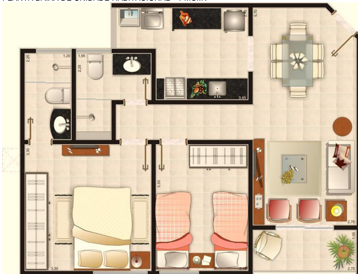
FIGURA 22 PLANTA BAIXA DE UNIDADE HABITACIONAL – PMCMV
