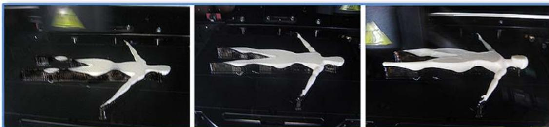
**Figura 3:33** Camadas intermediárias depositadas na impressão.
