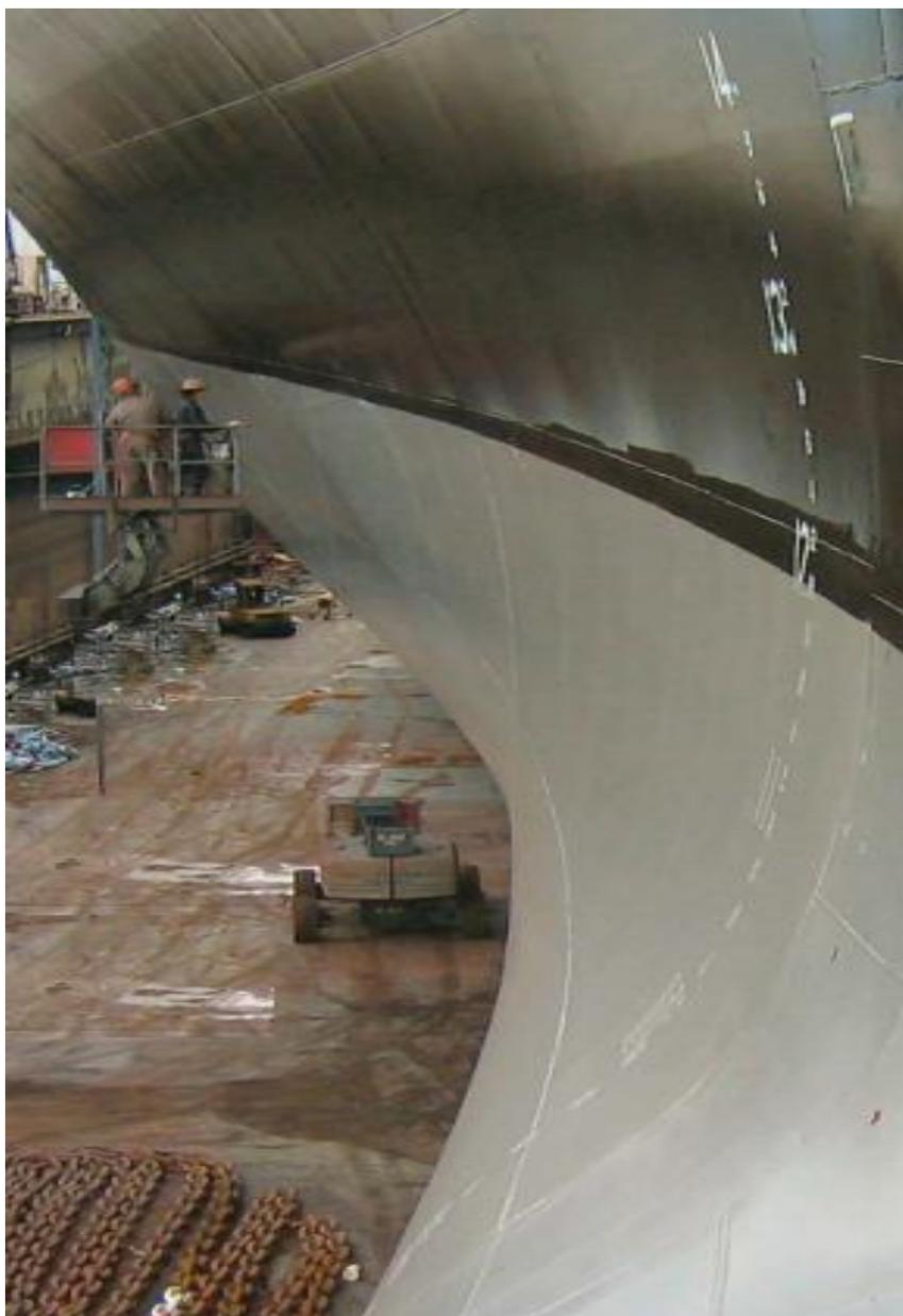
Figura 2- Detalhe da curvatura das chapas da proa de um navio S.W.S. (2011)
