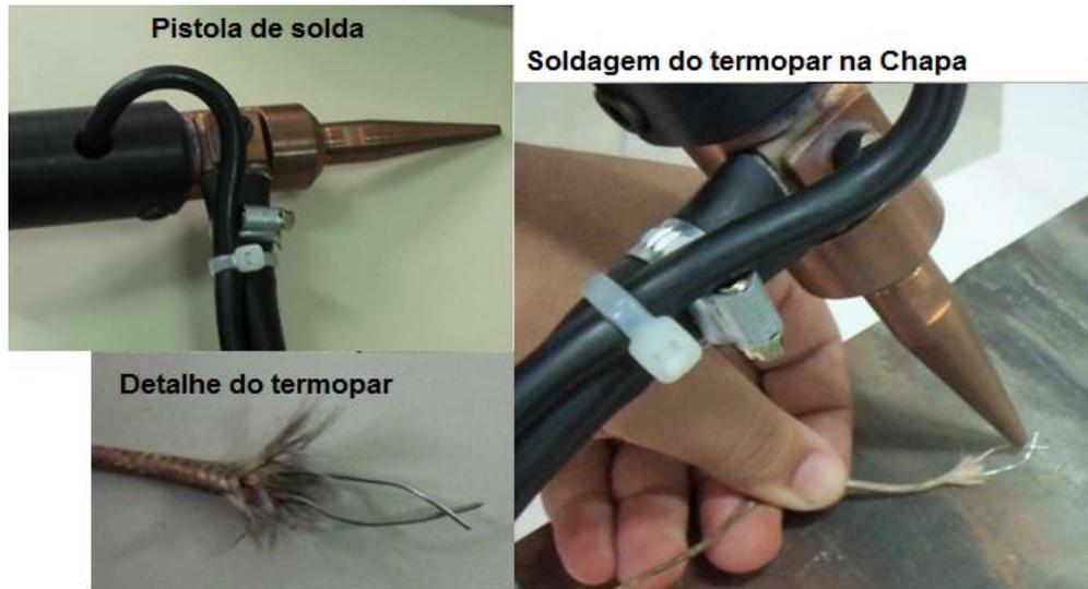
Figura 43- Detalhe da soldagem do termopar na chapa.
