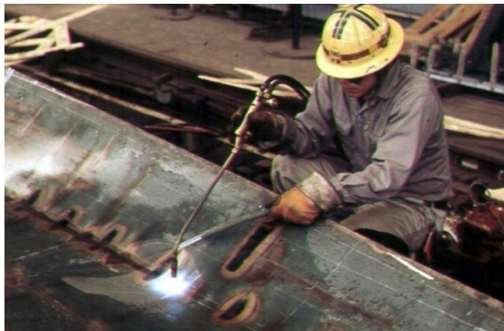
Figura 7- Detalhe de aplicação de linha de calor NSNET (1998)
