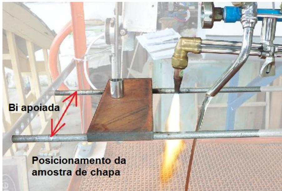
Figura 45- Detalhe do posicionamento da amostra de chapa bi apoiada.
