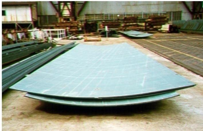
Figura 6- Detalhe da chapa com uma curvatura NSNET (1998)
