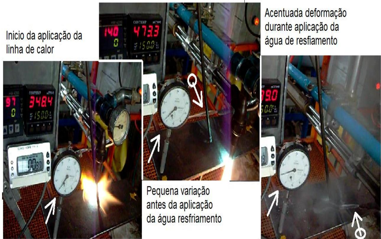
Figura 47- Apresentação do Experimento com a verificação da deformação em tempo real.
