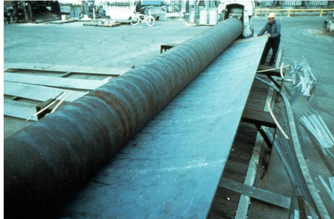
Figura 5- Detalhe do processo de calandragem em chapa NSNET (1998)
