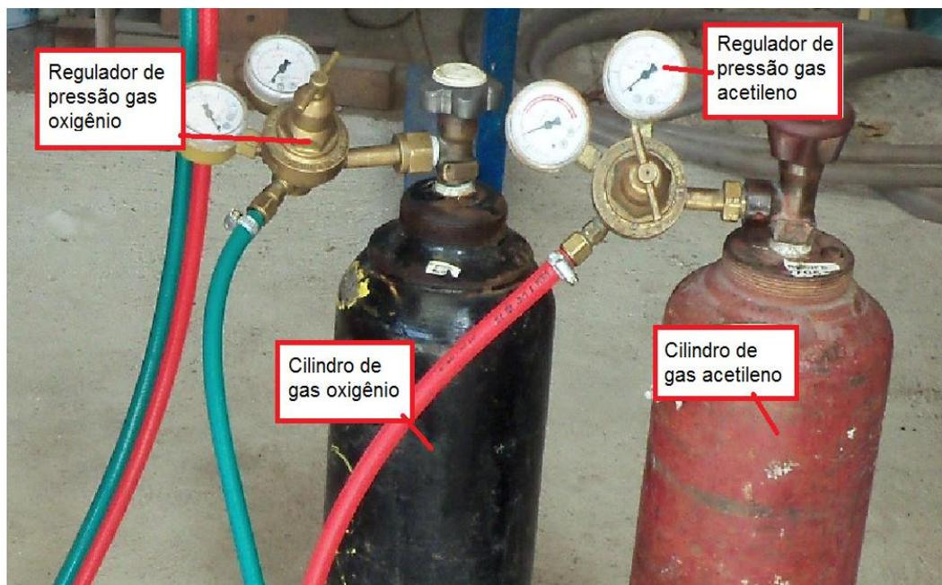
Figura 36- Apresentação do Sistema de gases oxigênio e acetileno.
