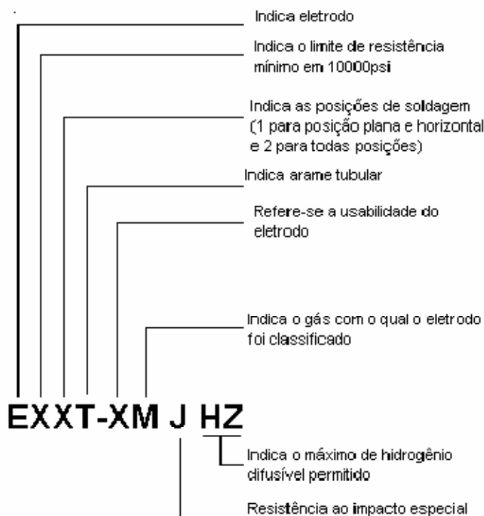
Figura 21 - Sistema de Classificação AWS para consumíveis de aço carbono e baixa liga (Bracarense, 2004)
