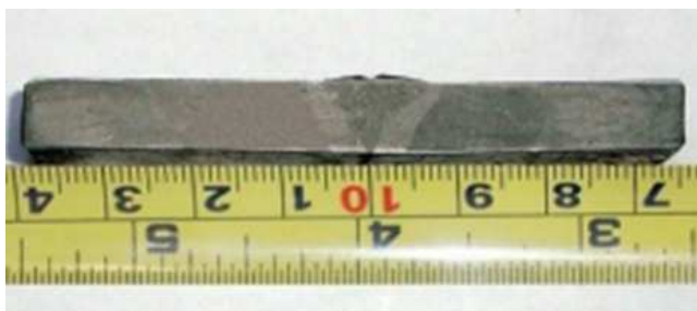
Figura 38 – Macrografia da ZTA de uma das soldas produzidas
