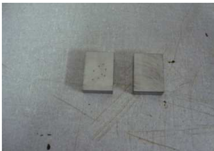
Figura 47 – Foto de amostras cortadas para o ensaio micrográfico
