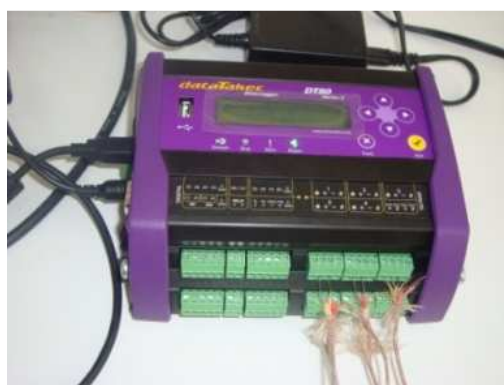
Figura 33– Foto detalhe do registrador de dados Data Taker DT 80
