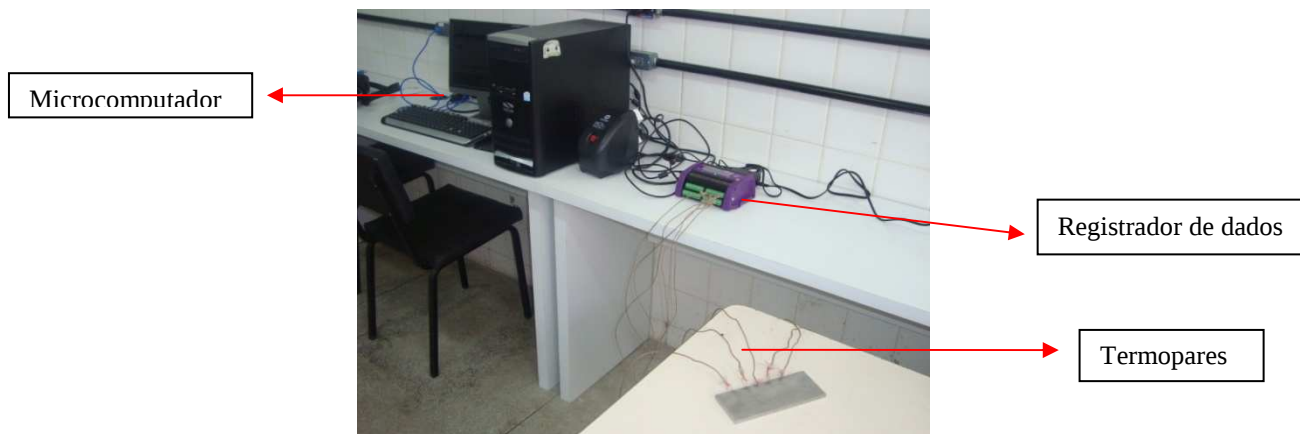
Figura 30 – Foto dos equipamentos utilizados para obtenção do ciclo de soldagem
