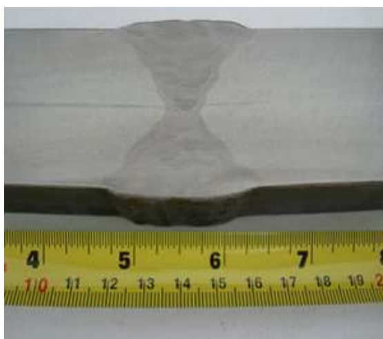
Figura 22 - Exemplo de Macrografia de uma solda (Colpaert, 2008)
