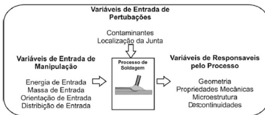
Figura 10- Esquema de monitoramento e controle da soldagem (Weiner et al, 1992)
