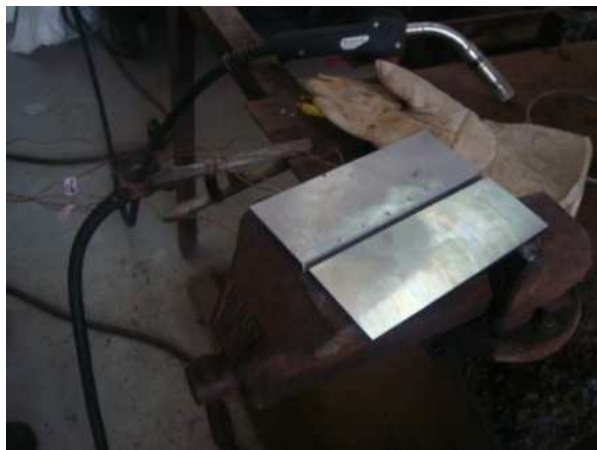
Figura 36 – Posicionamento do corpo de prova para soldagem
