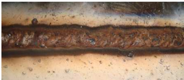
Figura 37– Foto de cordão de solda imediatamente após a soldagem
