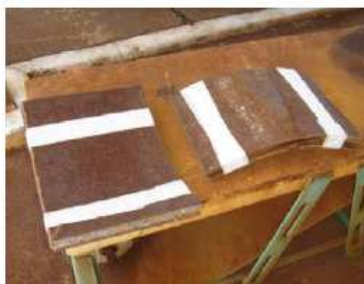
Figura 27 – Fracionamento dos anéis dos tubos pelo processo de oxi-corte
