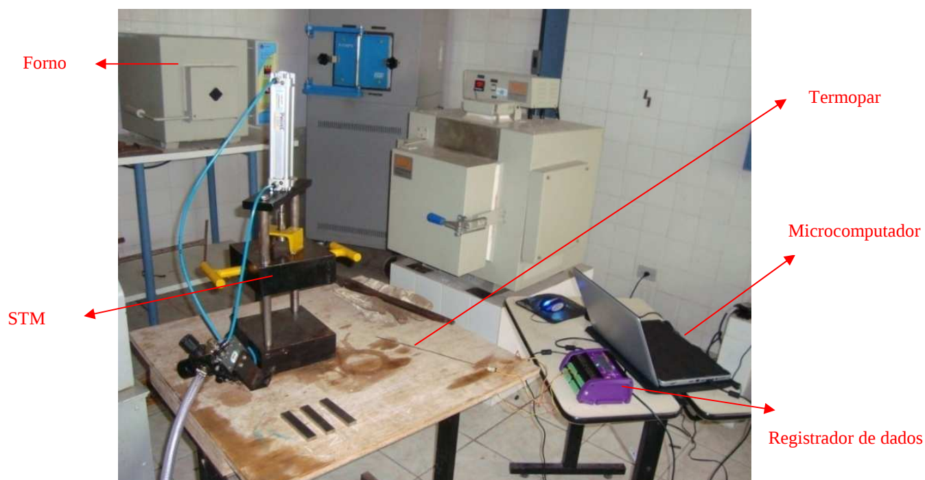
Figura 41– Foto dos equipamentos para reprodução do ciclo de soldagem
