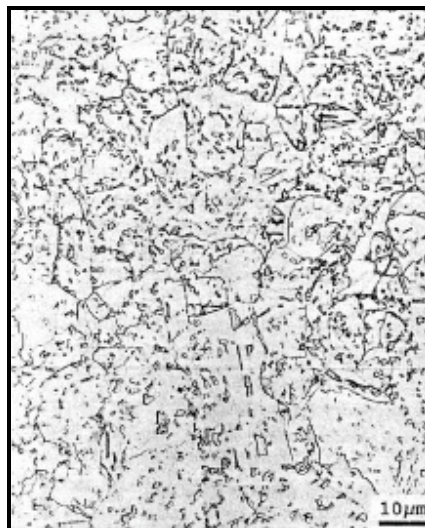
Figura 2.4 – Microestrutura constituída por Ferrita Granular (Santos, 2007)
