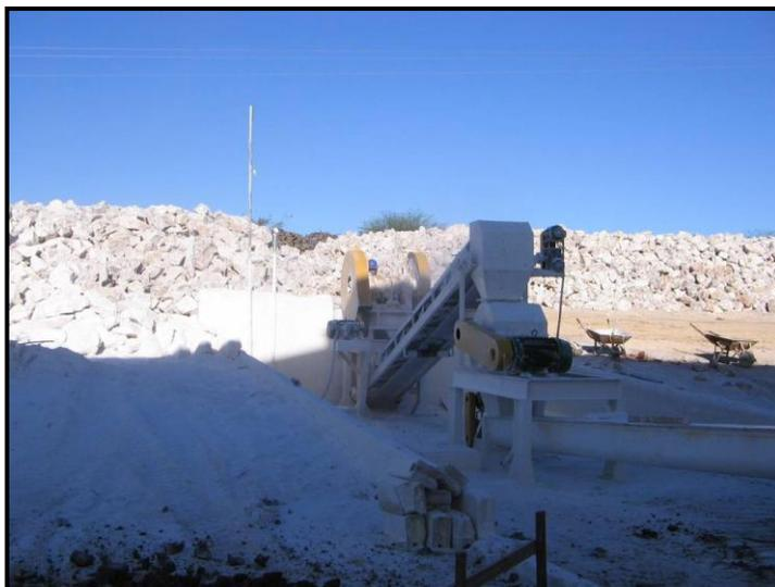
*Figura 1. 5 - Britagem e transporte de gipsita até o forno de calcinação(empresa AMGesso).*
