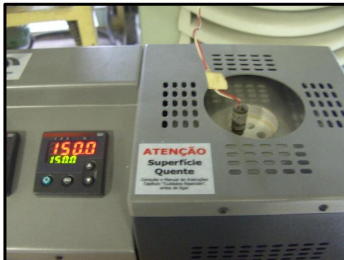
*Figura A2.3 – Aferição com banho de alta temperatura.*
