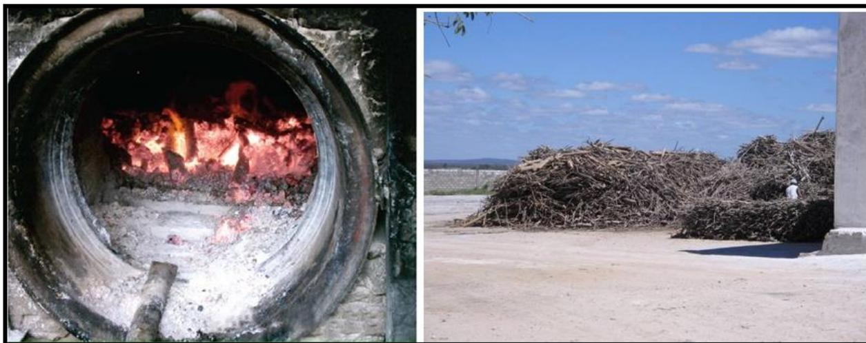
*Figura 1. 10* mostra a lenha utilizada e o sistema de fornalha comum nas calcinadoras de pequeno porte.
