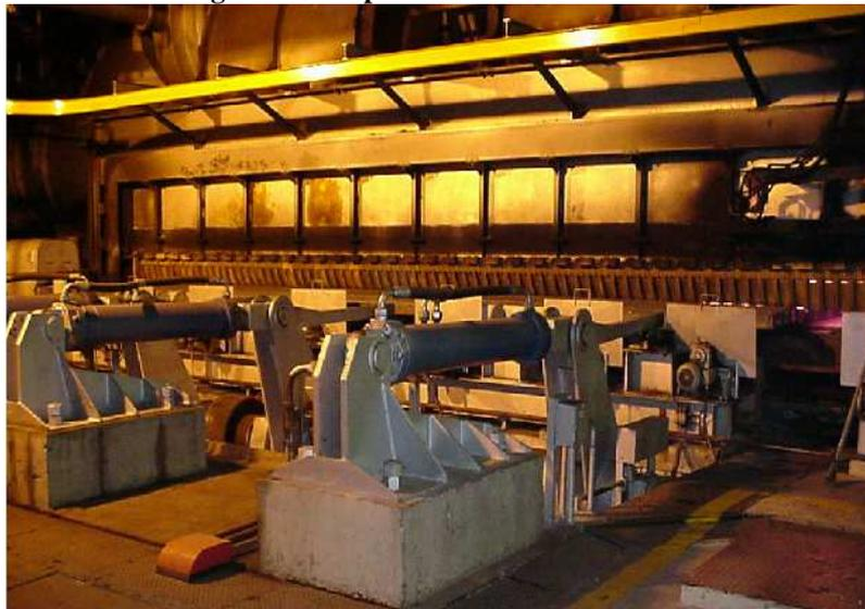
A extração é feita através do empurrador lateral, denominado de *pell bar*, que é uma lança a qual penetra no forno atingindo o tarugo em uma das extremidades, expulsando-o, até sua retirada total sobre a mesa de rolos de saída. A partir desse ponto, os tarugos seguem para as gaiolas de laminação.
