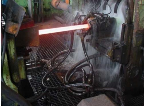
Figura 4 Sistema de resfriamento de cilindro de laminação
