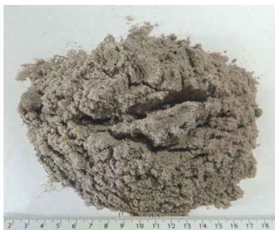
Figura 78 – Areia proveniente de depósitos eólicos (cobertura arenosa). Areia fina a média, bem selecionada.
