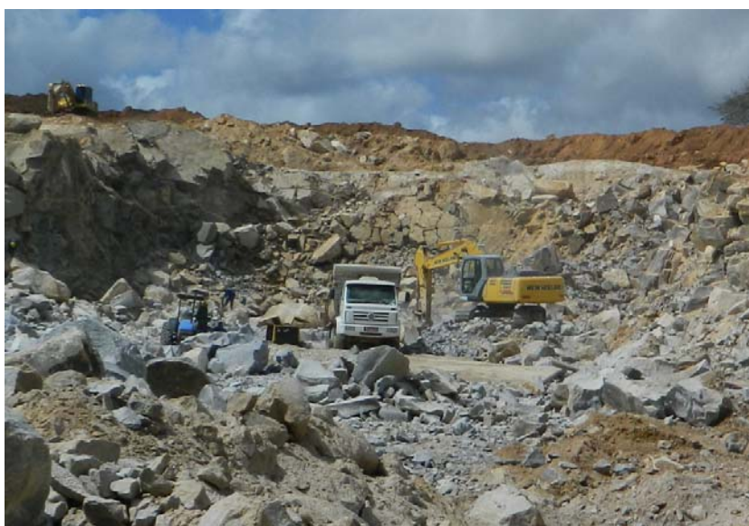
Figura 59 – Escavadeiras trabalhando sobre a pilha de rocha desmontada, município de Macaíba (localidade de Jundiaí, Pedreira Potiguar).
