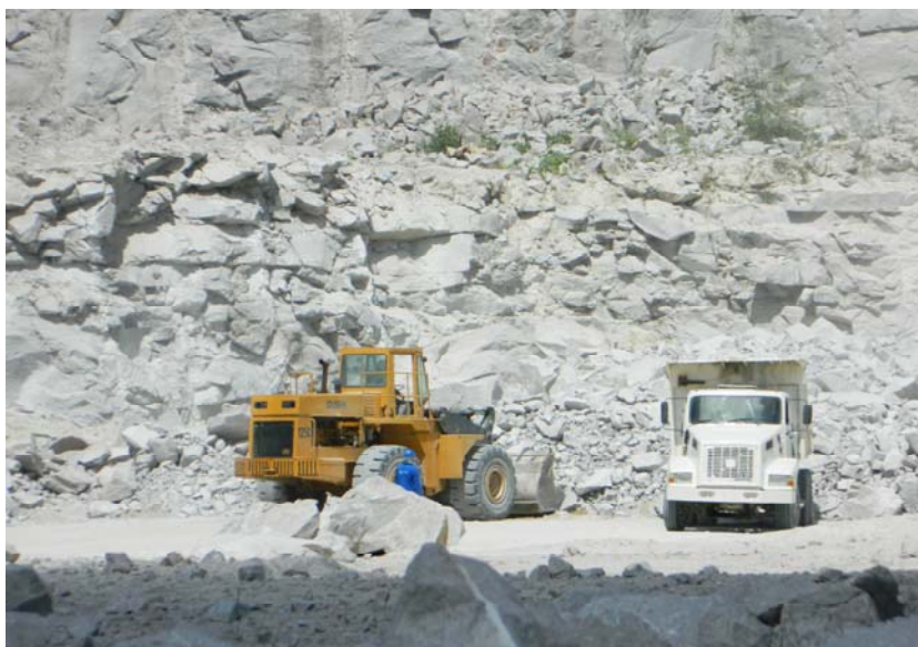
Figura 58 – Carregamento realizado por carregadeira sobre pneus, município de São Gonçalo do Amarante (localidade de Serrinha de Cima, Pedreira Serrinha).
