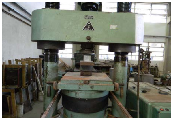
Figura 1 - Prensa hidráulica utilizada nos ensaios de compressão simples, Laboratório de Estruturas do Departamento de Engenharia Civil - UFPE.
