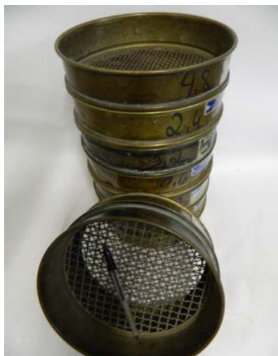
Figura 9 – Série de peneiras utilizadas nos ensaios de agregados miúdos (areias).
