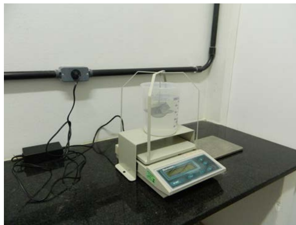
Figura 8 – Balança com resolução de 0,01g, utilizada nos ensaios, LAPLA/UFPE.
