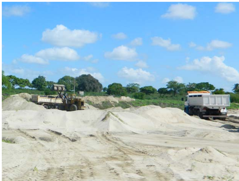
Figura 70 – Lavra com auxílio de pá carregadeira hidráulica no Rio Potengi (limite entre os municípios de Ielmo Marinho e São Gonçalo do Amarante (localidade de Pitombeira).
