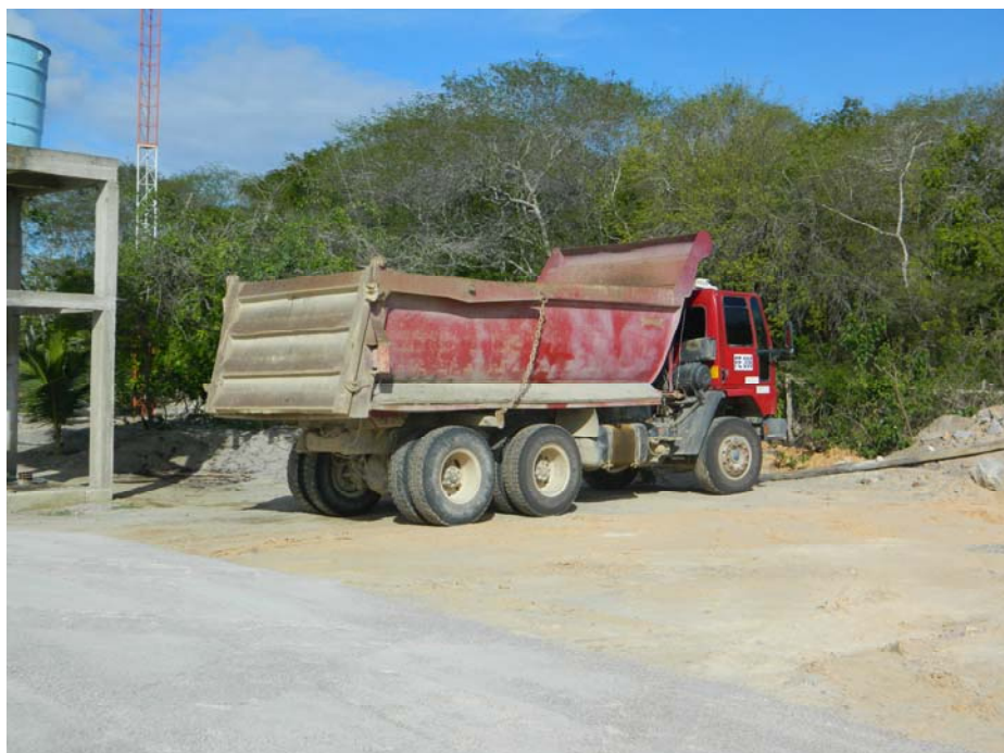
Figura 64 – Caminhão basculante rodoviário, equipamento mais utilizado no transporte de brita na RMN. Pedreira Potiguar, localidade Jundiá.
