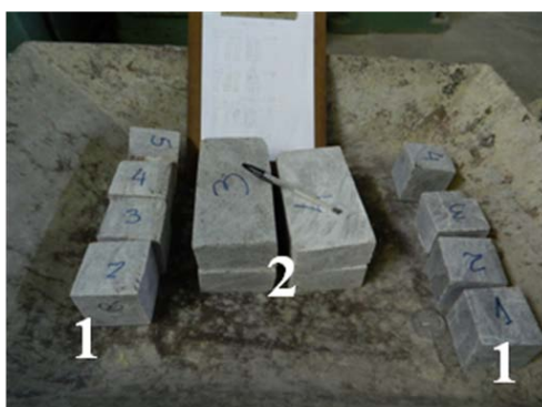
Figura 2 – Corpos-de-prova utilizados nos ensaios de compressão Simples (1) e ensaios de tração por flexão (2).
