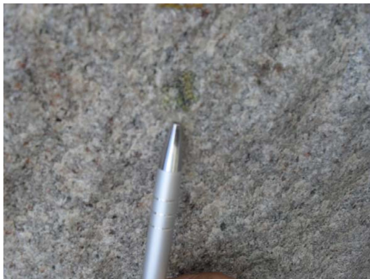
Figura 85 – Presença de minerais metálicos (inclusive sulfetos), no maciço rochoso em Serrinha de Cima, na frente de lavra analisada.
