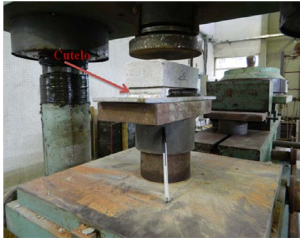
Figura 3 - Prensa hidráulica utilizada nos ensaios de tração por flexão, LAPLA/Laboratório de Estruturas do Departamento de Engenharia Civil/UFPE.
