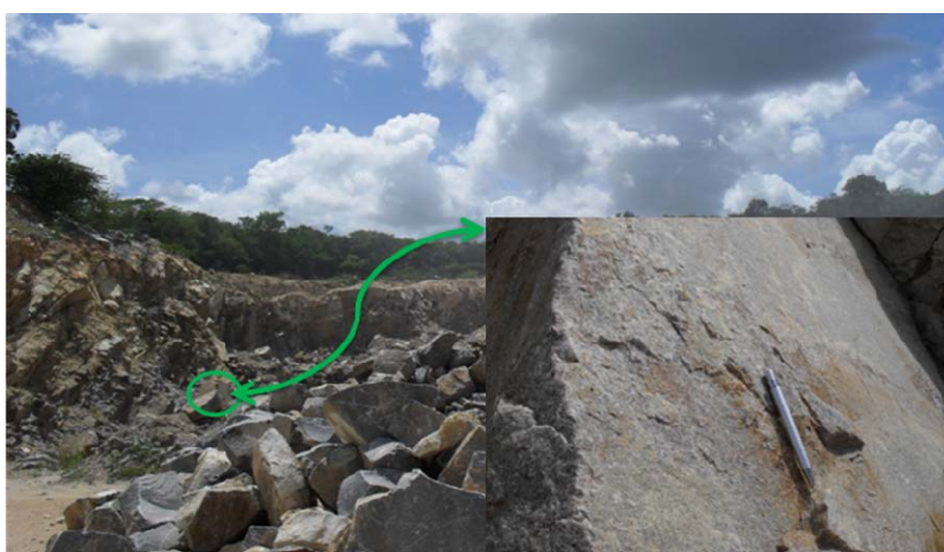
Figura 83 – Marcador de deformação tipo fratura de cisalhamento cisalhamento expressando superfície Alongante 035Az – 215Az (55/125Az) e “degraus” indicativos de movimento com forte componente segundo a linha de maior declive, frequência 3/metro, evidenciando o estágio /condição dútil do maciço rochoso.
