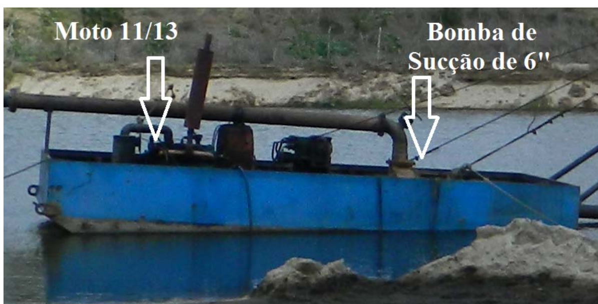
Figura 68 – Draga com bomba de sucção de 6" (seis polegadas) acoplada a motor diesel de 6 cilindros 11/13 comumente utilizada na exploração de areia na RMN (no município de Ielmo Marinho).
