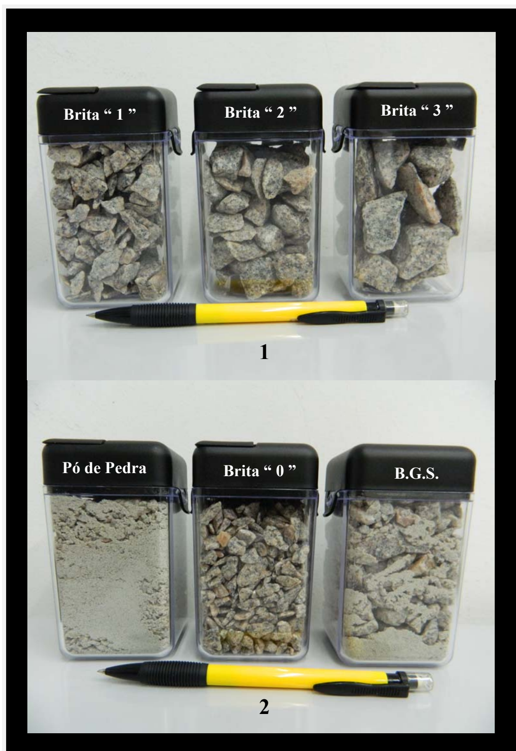
Figura 75 – Principais produtos comercializados pelas pedreiras da RMN, 1 (brita 1, 2 e 3) e 2 (pó de pedra, brita 0 e brita graduada simples – BGS).
