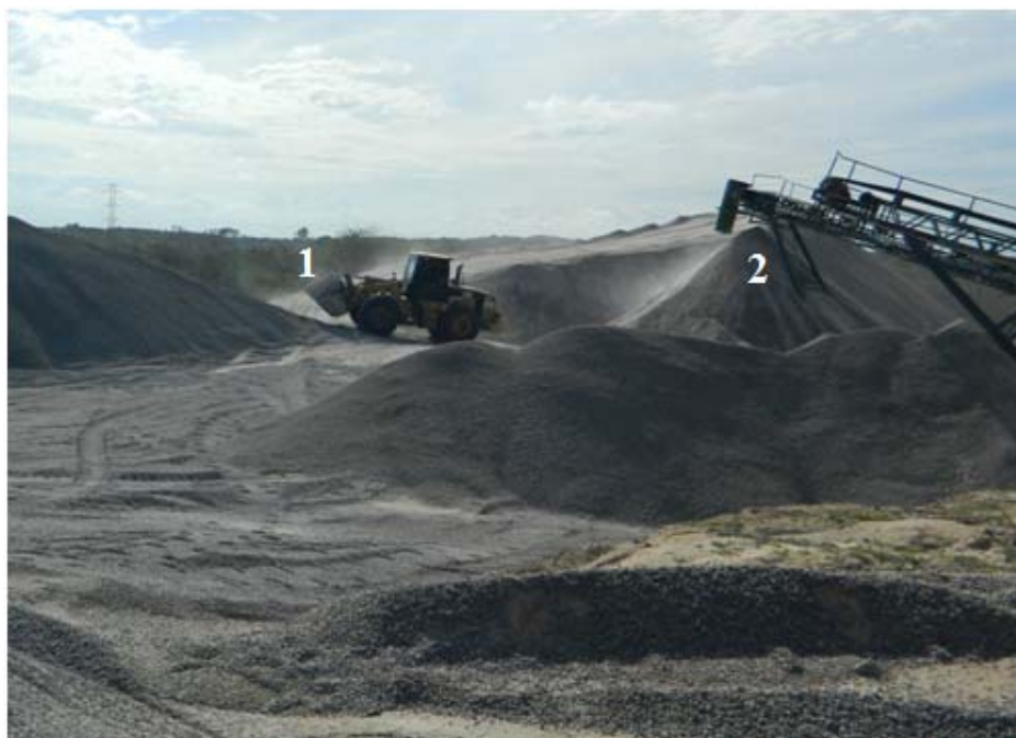
Figura 63 – Carregamento para expedição pela forma mecanizada (1, com pá carregadeira) ou automatizada (2, diretamente das correias, Pedreira Potiguar, localizada em Macaíba (localidade Jundiá).
