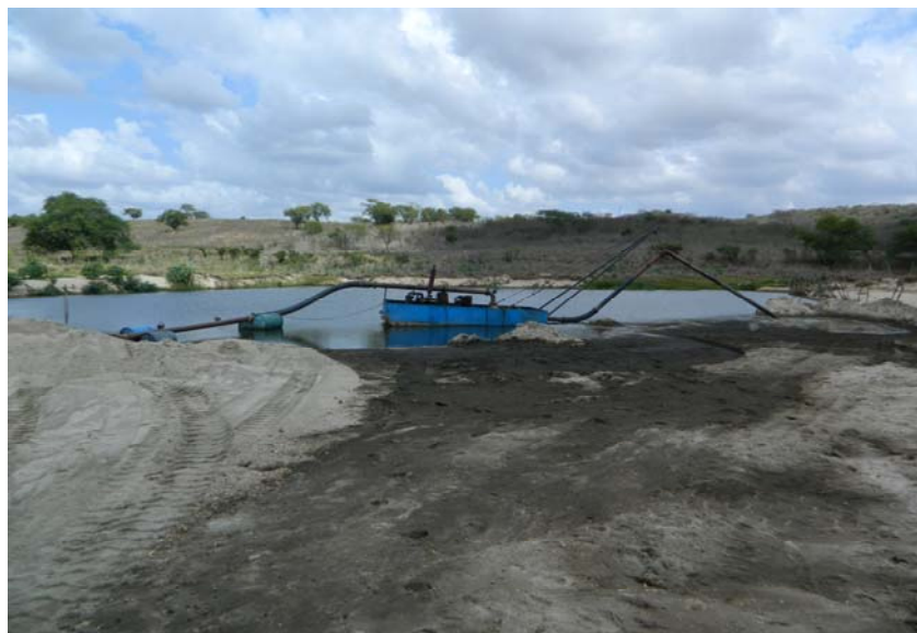
Figura 69 – Dragagem por barça com ancoragem fixa nos limite dos municípios de Ilmo Marinho e São Gonçalo do Amarante.
