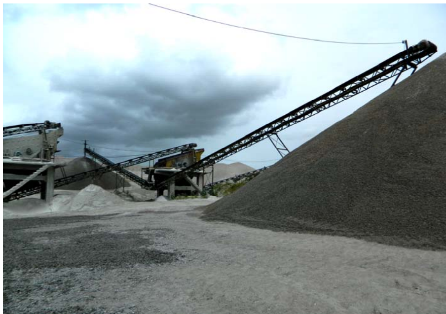
Figura 62 – Etapa de classificação do material britado (peneiras com decks), município de São Gonçalo do Amarante (na localidade Serrinha de Cima, Pedreira Serrinha).
