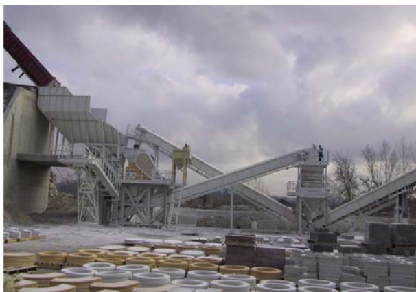
Figura 30 - Transporte da brita entre os britadores e/ou rebitadores por correias transportadoras.
