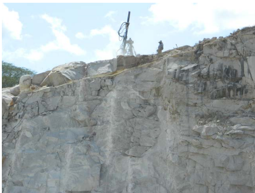
Figura 60 – Perfuração da rocha para carregamento com explosivo, município de São Gonçalo do Amarante (localidade Serrinha de Cima, Pedreira Serrinha).
