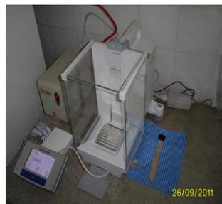
(d) Balança analítica XS 105, Mettler Toledo.
