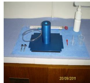
(f) Calibrador padrão de vazão PV 470 e manômetro de coluna d'água em forma de "U".
