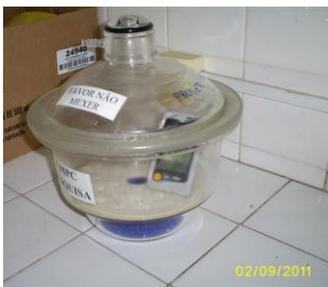
(c) Dessecador e termo-higrômetro, Icel HT-209.
