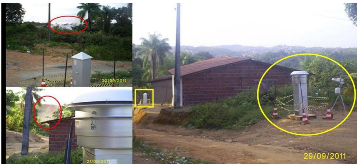
**Figura 16** – Estação de avaliação com destaque para os AGVs (PTS e MP<sub>10</sub>).
