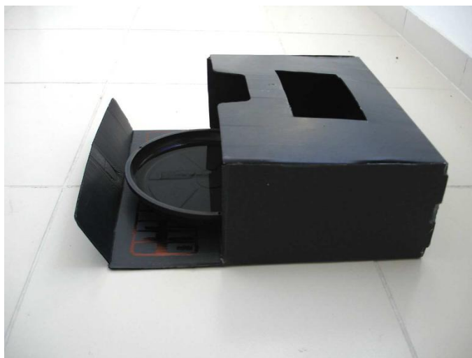
Figura 6 – Armadilha de oviposição para coleta de ovos de Culex quinquefasciatus , BR-OVT.
