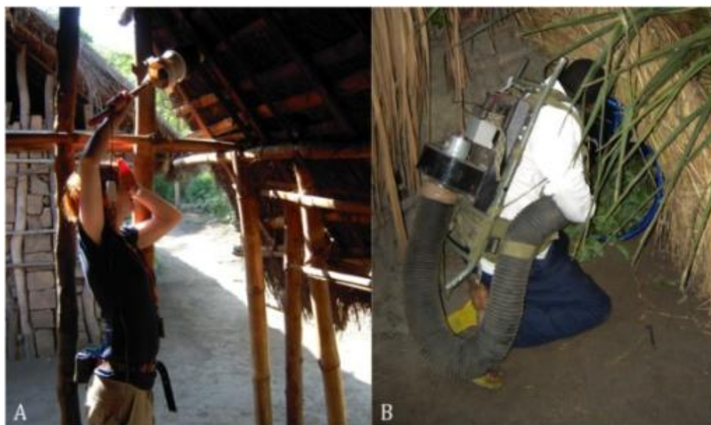
Figura 9 – Aspirador Prokopack (A) e aspirador backpack CDC, utilizados na coleta de mosquitos adultos.
