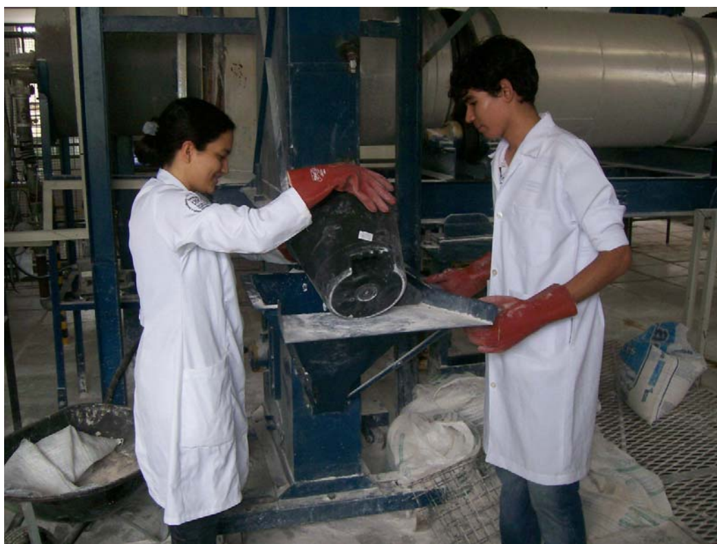
Figura 3.20 – Processo de alimentação do forno – 175 Kg/h
