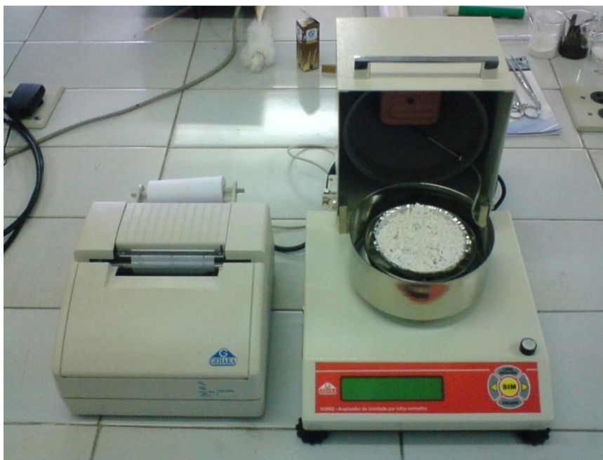
Figura 3.22– Analisador de umidade modelo GEHAKA IV 200
