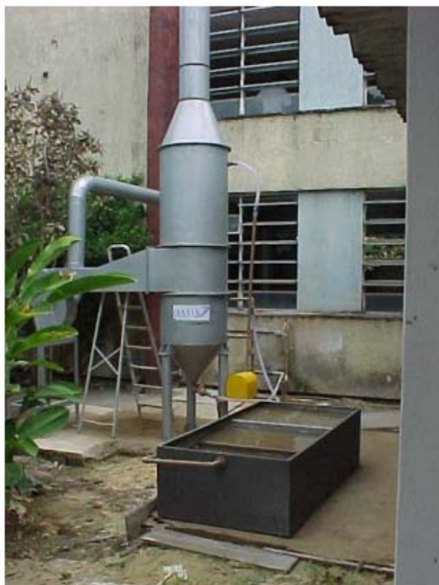
Figura 3.15 - Vista da coluna de lavagem dos gases efluentes do forno piloto
