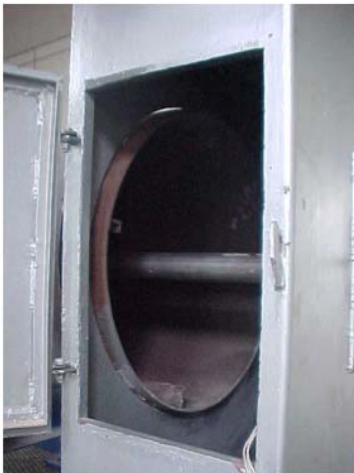
Figura 3.9 - Vista da extremidade de saída do forno piloto destacando-se as aletas e o conduto suporte para os termopares
