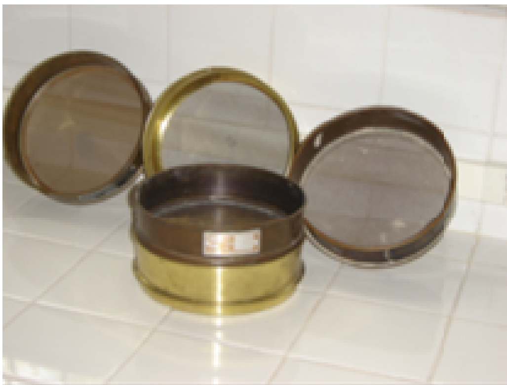
Figura 3.2 – Jogo de peneiras seriado com aberturas diferentes
