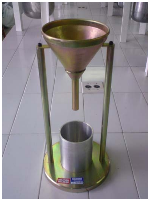
Figura 3.23 – Aparelho para determinação da massa unitária.
