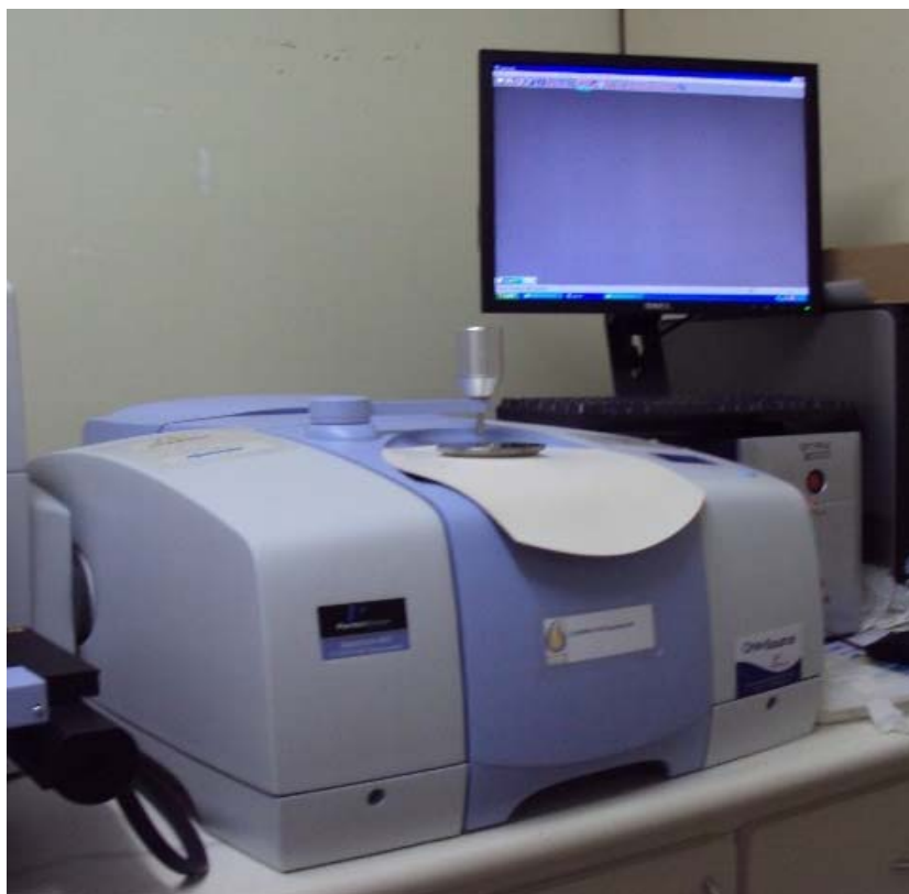
Figura 3.31 - Espectrofotômetro NIR/MID spectrum 400 da marca Perkin Elmer
