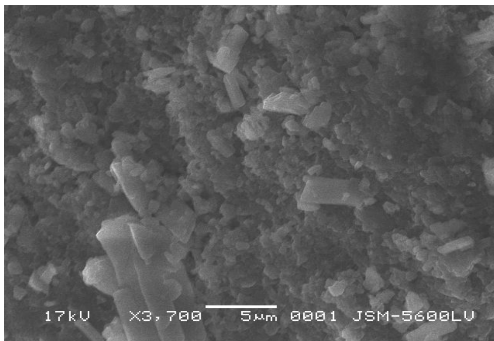
Figura 4.37 – Micrografia dos cristais de gesso 100% resíduo (amostra 5)
