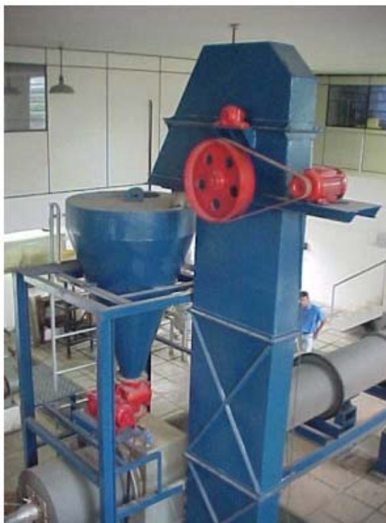
Figura 3.12 - Vista do conjunto elevador de caçambas e silo responsáveis pela alimentação de sólidos
