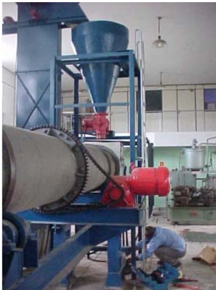
Figura 3.10 - vista do conjunto eletro-mecânico responsável pelo movimento de rotação do forno
