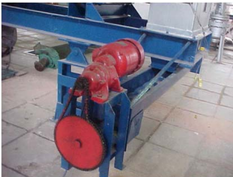
Figura 3.13 - Vista do transportador helicoidal responsável pela coleta do gesso produzido no forno piloto
