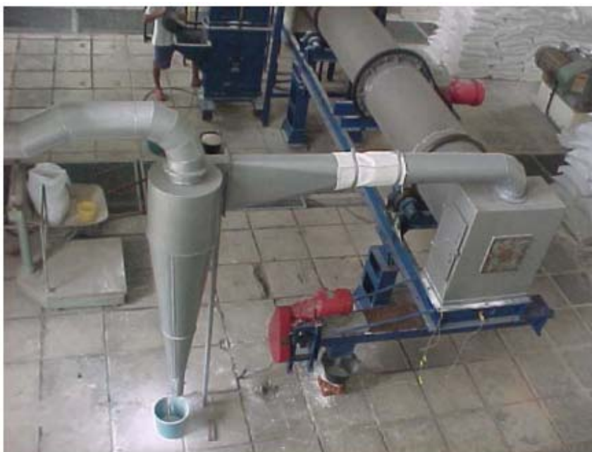
Figura 3.14 - Vista do ciclone instalado na saída dos gases efluentes do forno piloto
