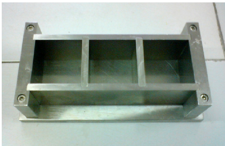
Figura 3.26 – Moldes cúbicos para confecção de corpos de prova (aresta 50 mm)
