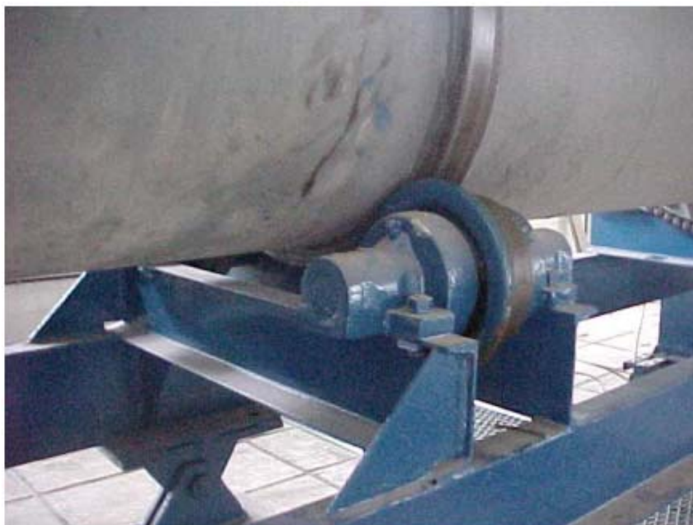
Figura 3.11 - Vista do tipo de mecanismo de rolamento e apoio do forno piloto
