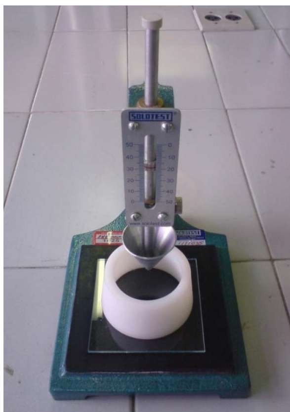
Figura 3.24– Aparelho de Vicat modificado
