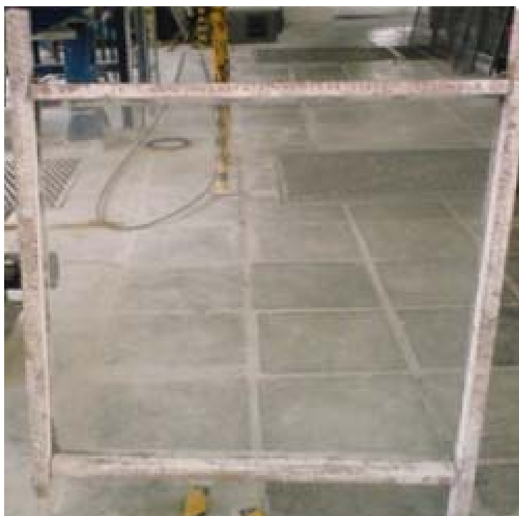
Figura 3.1 – Separação de partículas acima de 2 mm: Peneira manual
