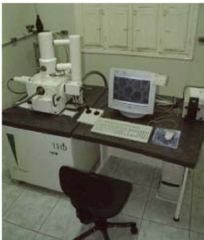
Figura 3.28 – Microscópio eletrônico de varredura modelo: JSM 5600 LV JEOL
