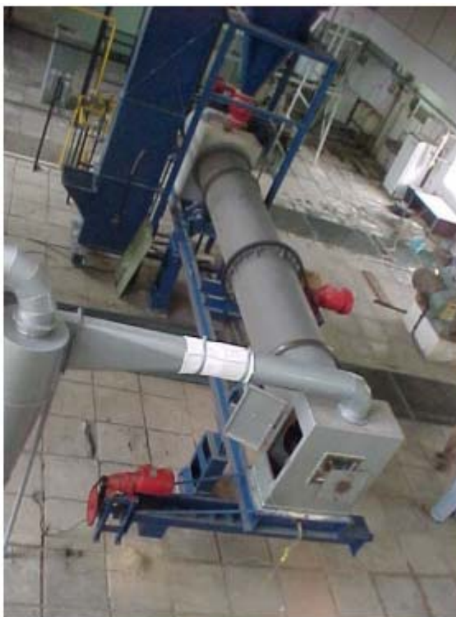
Figura 3.8 - Vista do forno rotativo piloto para calcinação da gipsita – DEQ/UFPE
