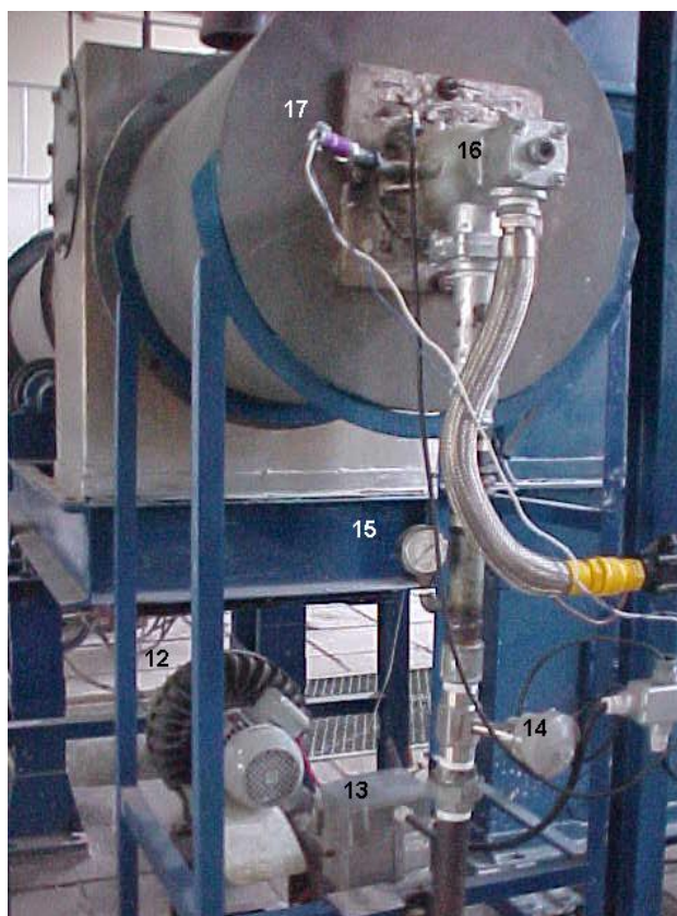
Figura 3.18 – Sistema de alimentação do ar de combustão e queimador
