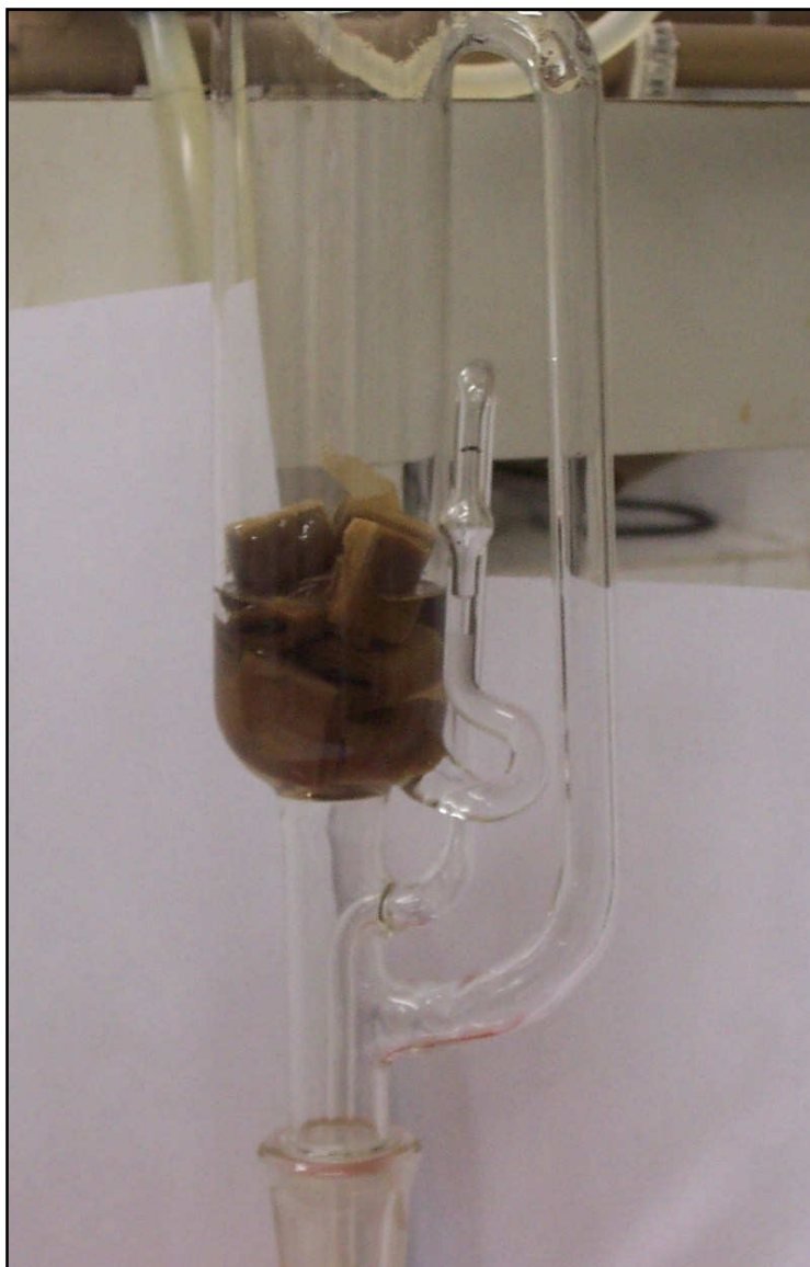
Figura 5 – Amostra de papel em extrator soxhlet .
