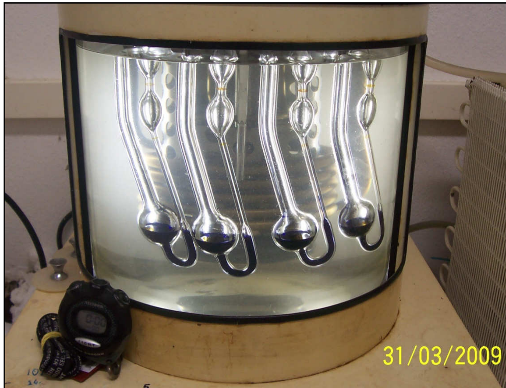
Figura 6 – Medida dos tempos de escoamento em banho termostático de silicone a 20,00 \pm 0,05 °C.
