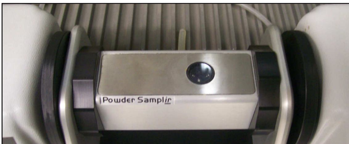
Figura 8 – Detalhe do acessório de reflectância difusa.
