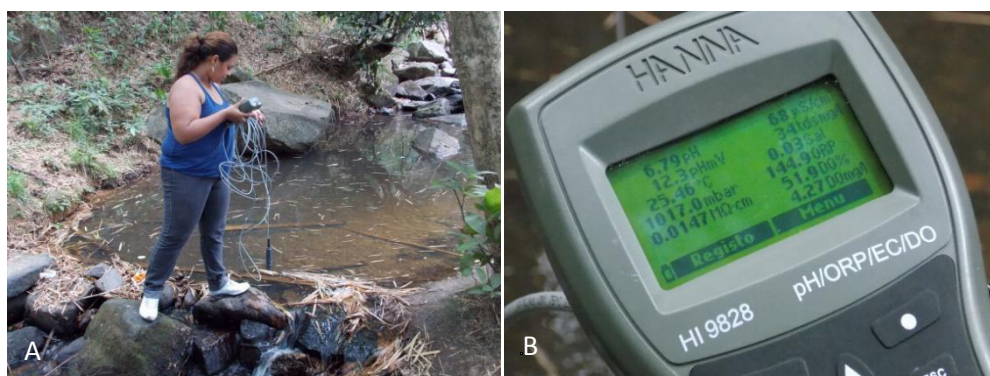
Figura 4 - Medição em campo das condições físicas e químicas da água (A) por meio de sonda multiparâmetro (B).
