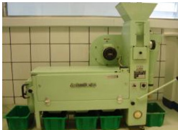
Figura 3 – Limpador de Grãos Labofix 90
