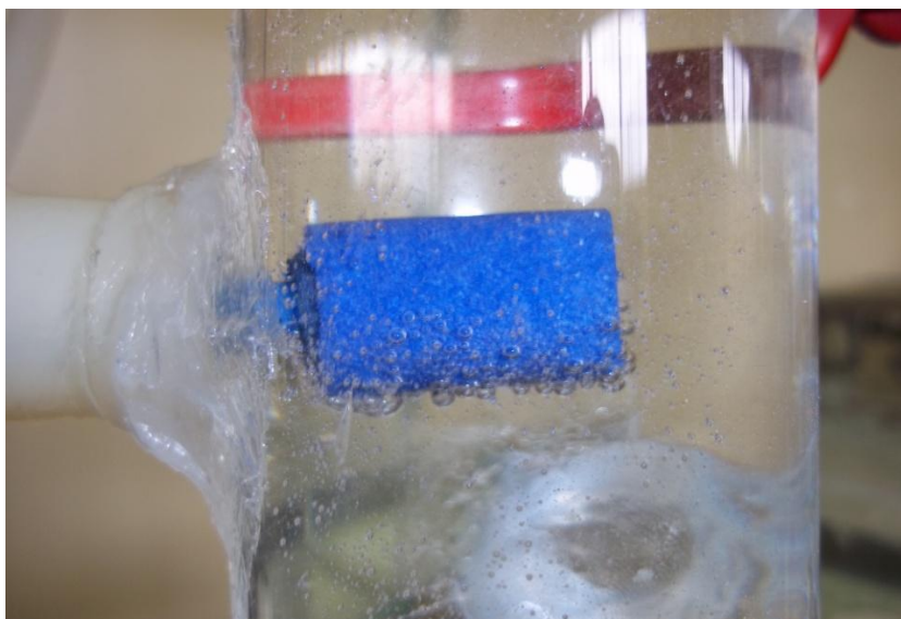
Figura 26 - Borbulhador do sistema de purificação
