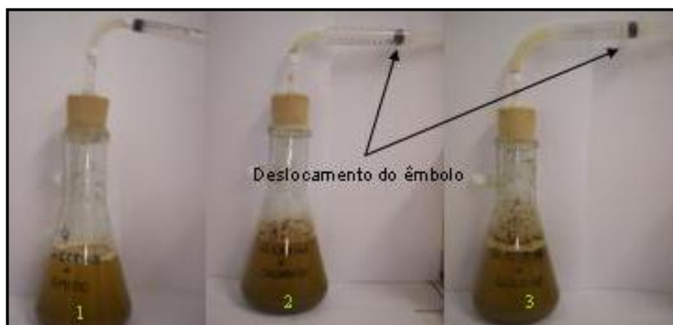
Figura 15 - Produção de biogás a 35°C, a pressão atmosférica
