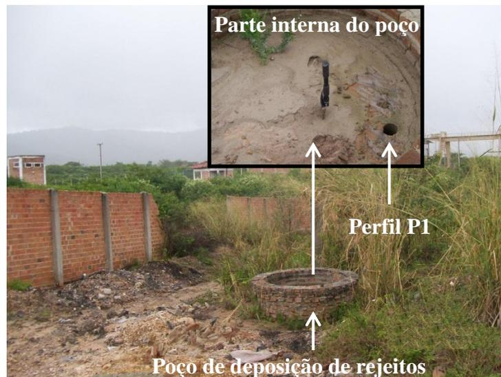
**Figura 3.4:** Perfil P1 (BJ-02) coletado no poço de deposição de rejeitos de fundição de chumbo.
