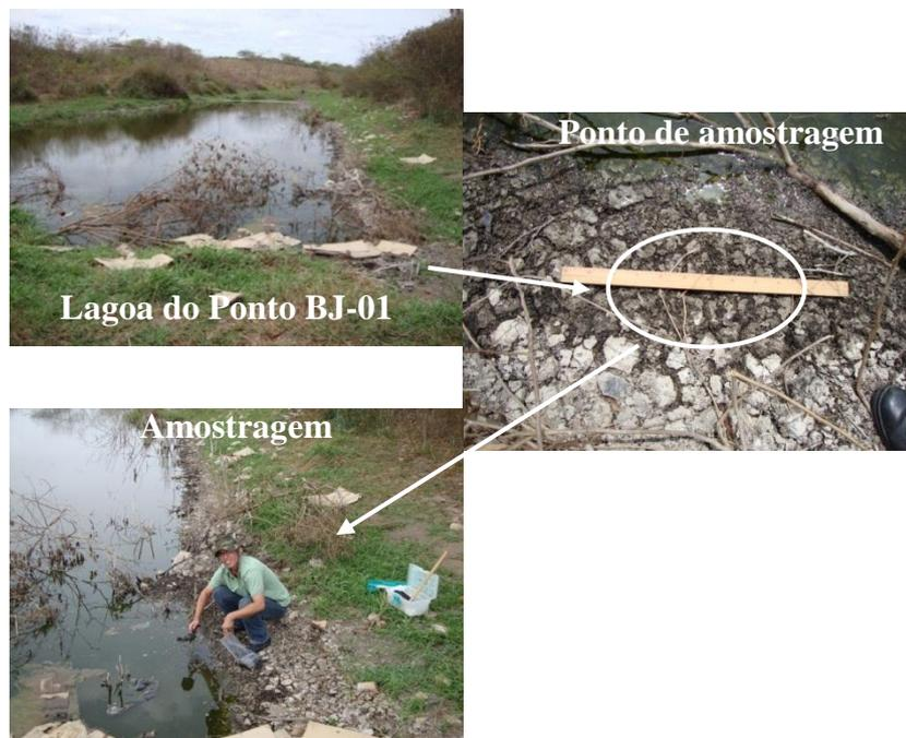
**Figura 3.3:** Coleta de solo realizada próxima aos focos emissores, junto da lagoa.
