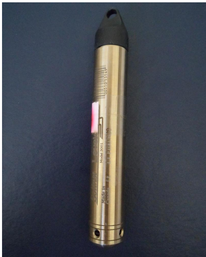
Figura 5. Registrador de nível automático utilizado no slug test.
