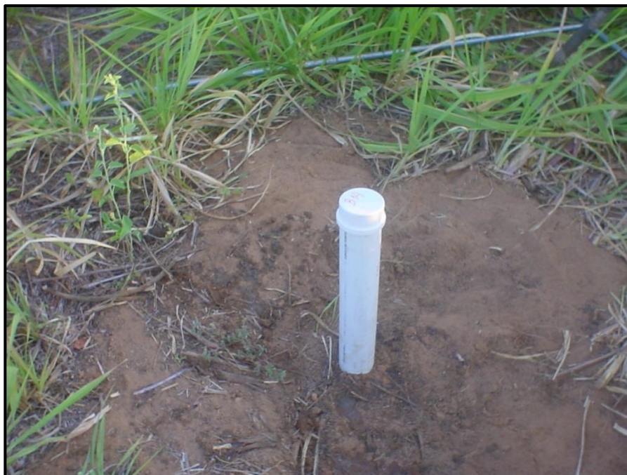
Figura 3. Piezômetro instalado na área da barragem subterrânea.
