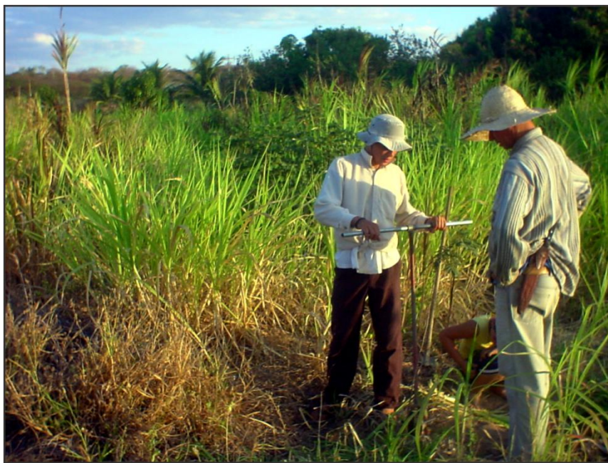
Figura 2. Execução das sondagens a trado manual.
