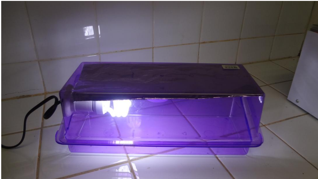
Figura 4.23 – Câmara de iluminação projetada para etapa de lift-off
