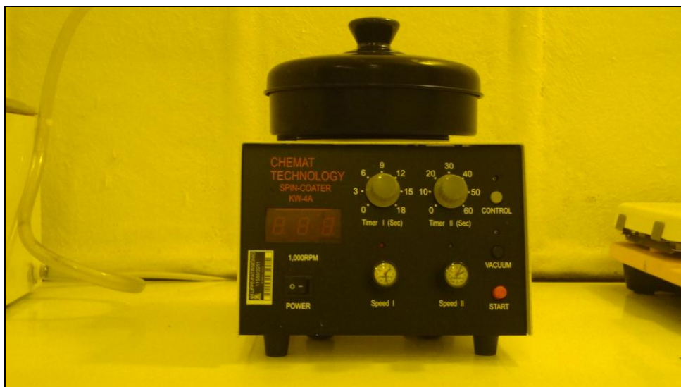
Figura 4.4 – Spin coater utilizado para a preparação dos filmes de fotoresina.
