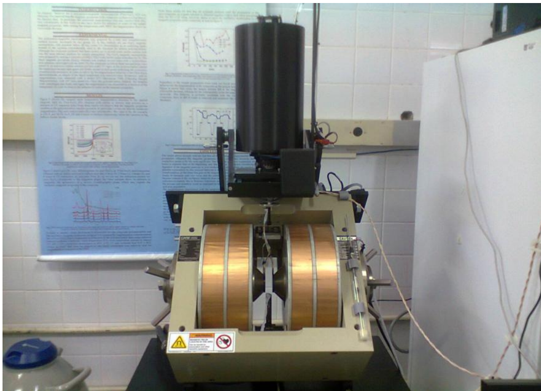
Figura 5.1 – VSM utilizado na obtenção das curvas de histerese das amostras obtidas.
