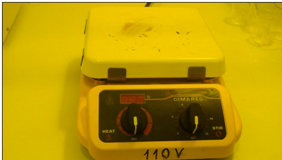
Figura 4.7 – Chapa aquecedora utilizada para a etapa de soft bake .
