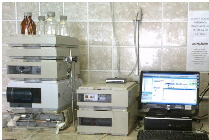
**Figura 4.8** - Cromatógrafo líquido utilizado na quantificação de PBZ (Fonte do autor)
