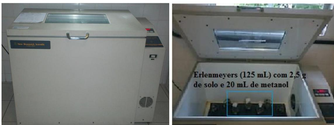
**Figura 4.4** - Incubador rotativo utilizado a extração de PBZ dos solos (Fonte do autor)
