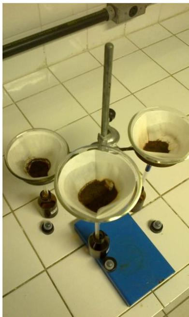
**Figura 4.5** - Filtração durante a preparação de amostras para quantificação do PBZ (Fonte do autor)
