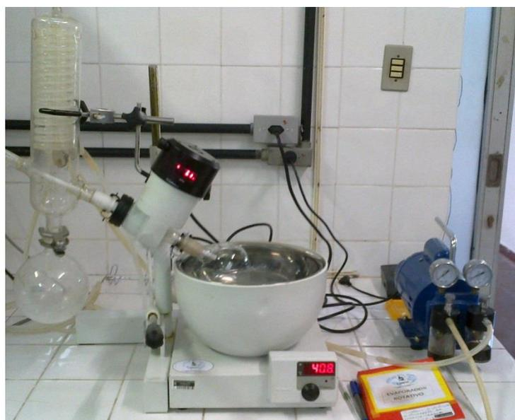
**Figura 4.6** –Evaporação durante a preparação de amostras para quantificação do PBZ (Fonte do autor)
