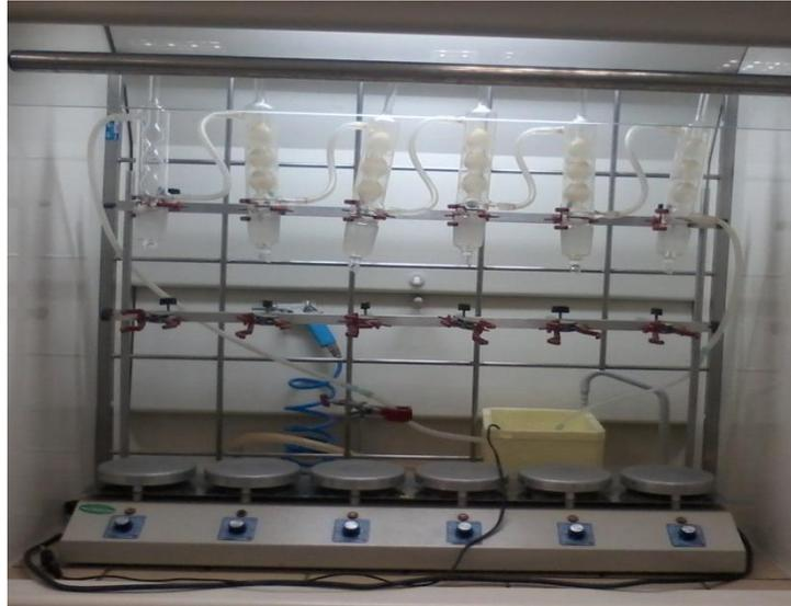
**Figura 4.1** – Sistema de extração com aparelho Soxhlet (foto do autor).
