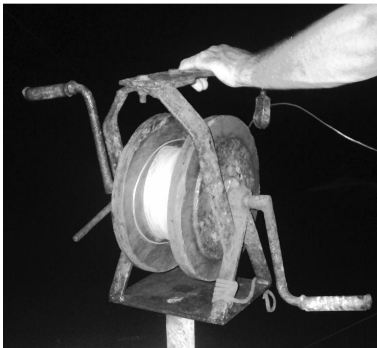
Fig. 5. Sistema de molinete puxado manualmente para facilitar o içamento do peixe
