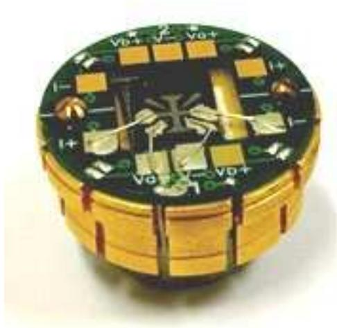
**Figura 3.4** *Puck* do PPMS com a amostra supercondutora de Nióbio e os contatos. Atentar para a disposição dos contatos seguindo o método das quatro pontas: nos pontos exteriores (I+ e I-) injetamos corrente elétrica e nos pontos interiores (Va+ e V-) medimos a voltagem.
