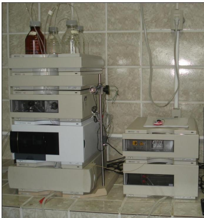
**Figura 4.7:** Equipamento de cromatografia líquida de alta eficiência (Agilent, série 1100) utilizado para a determinação de concentrações de substrato, produtos e inibidores.
