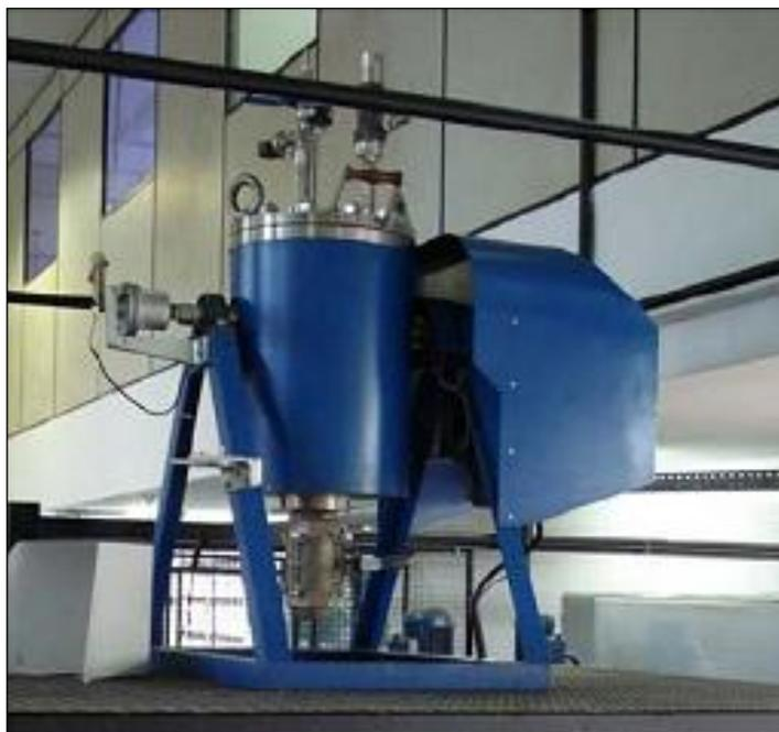
**Figura 4.1:** Reator (REGMED AU/E-20) utilizado para a obtenção do hidrolisado hemicelulósico.
