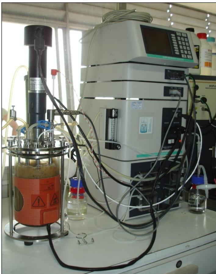
**Figura 4.5:** Biorreator de bancada instrumentado (New Brunswick Scientific, Bioflo 110) utilizado nos experimentos de caracterização cinética das linhagens.
