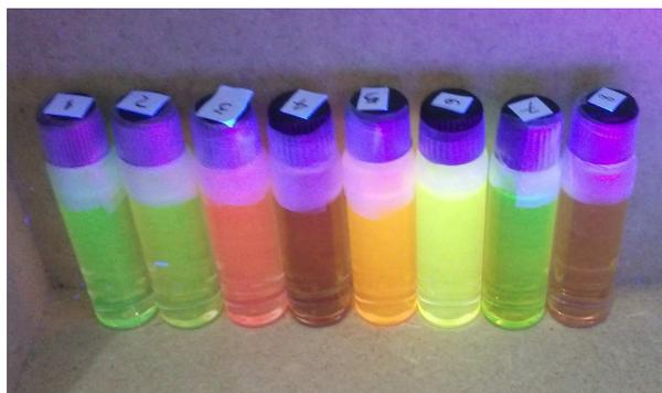
Fig.5: Exemplo da fluorescência de *QDs* de CdTe sintonizável com o tamanho. Comprimento de excitação: 365 nm.
