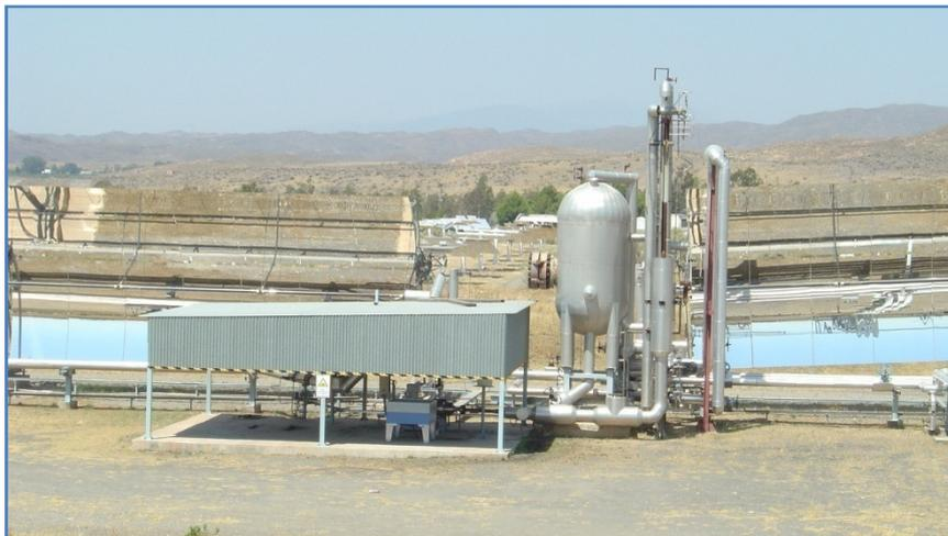
Figura 11 – Separador de líquido/vapor.
