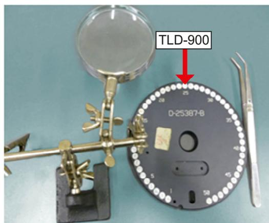
**Figura 3:** Disco contendo 50 TLD-900, ladeado por instrumentos utilizados no manuseio.
