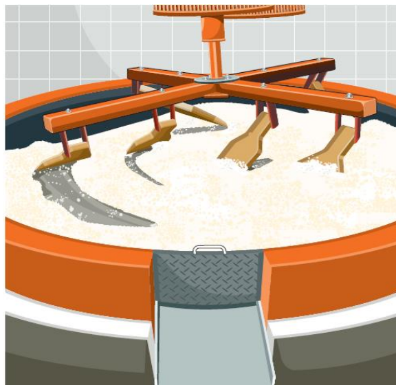
Figura 9 - Torrador com giro mecânico.
