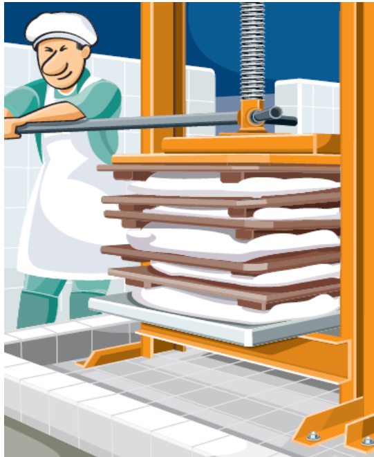
Figura 7 Prensa manual utilizada no processamento de farinha de mandioca.
