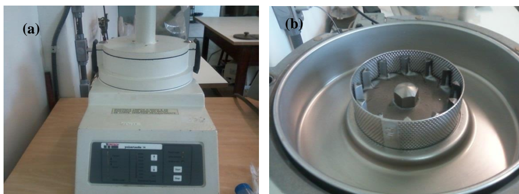
Figura 17 – (a) Moinho rotativo PULVERISETTE 14 da FRITSCH. (b) Parte interna do moinho.
