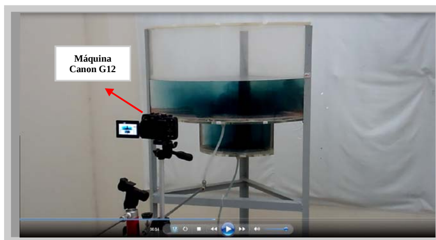
Figura 13 - Sistema de aquisição dos resultados experimentais
