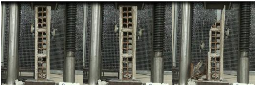
Figura 4.15 - Ruptura do prisma 3 blocos com traço 1:2:9 revestimento 20 mm (à galga)
