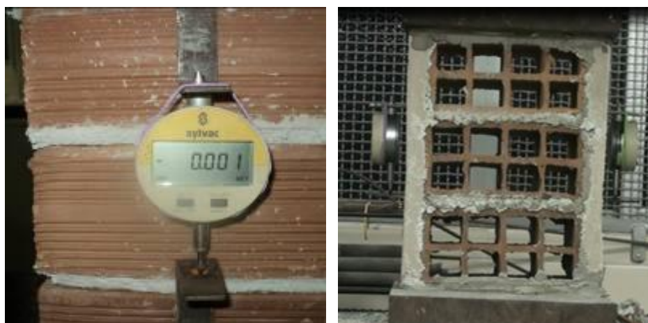
Figura 3.13 - Placa de apoio superior e inferior com deflectômetro e Prismas com base de apoio dos deflectômetros colada
