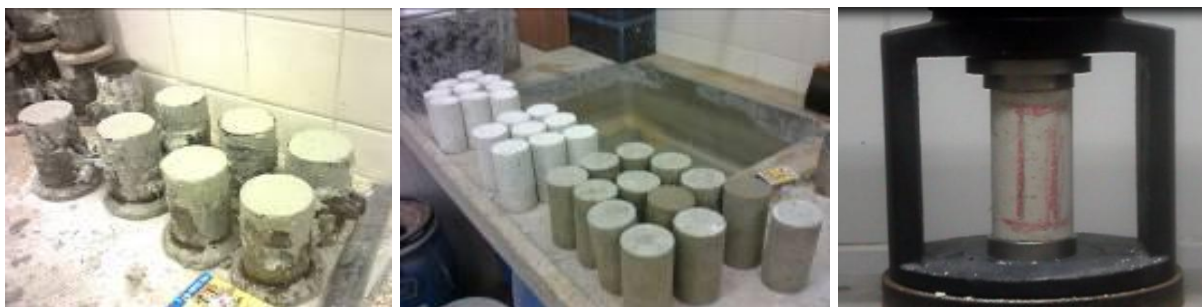
Figura 3.4 - Moldagem e ruptura dos corpos de prova de argamassa
