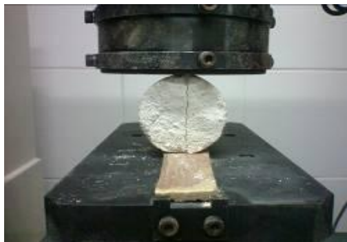
Figura 3.5 - Ensaio de resistência à tração por compressão diametral
