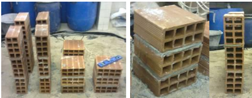
Figura 3.6 - Confeção dos Primas ao chato (tijolo deitado) e à galga (tijolo em pé)
