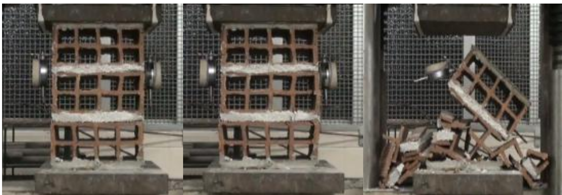
Figura 4.9 - Ruptura do prisma sem revestimento ao chato
